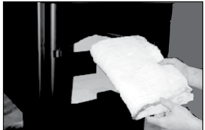
Figure 22.3 - Laine céramique isolante
