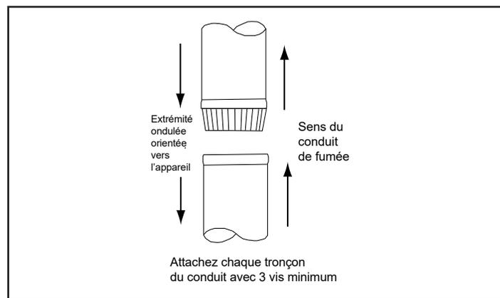
Figure 16.3 Carneau (tuyau d'appareil)
