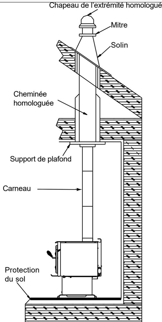
Figure 15.1 - Chiminée préfabriquée pour l'intérieur
