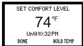
REMARQUE : La température de consigne doit être de 3 degrés supérieure à celle de la pièce pour que le foyer se mette en marche.
