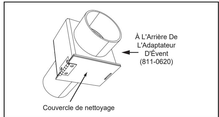
Figure 22.2 - Adaptateur de ventilation arrière (811-0620)
