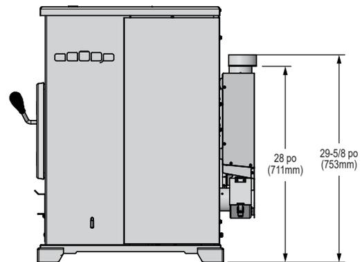
Figure 9.4 - Vue de côté avec Événement du Haut de l'Adaptateur (TPVNT-5) et de 3 à 4 pouces de Décalage de l'Adaptateur (811-0720)
