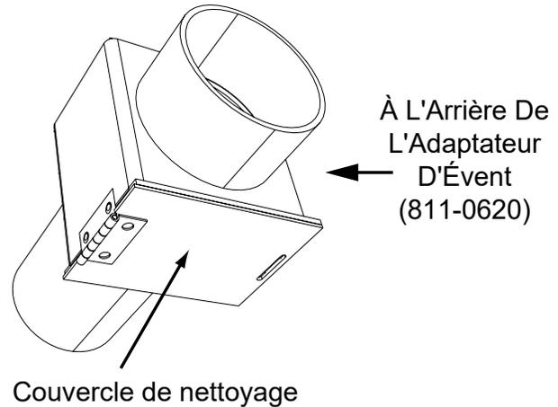
Figure 23.2 – Adaptateur de ventilation arrière (811-0620)
