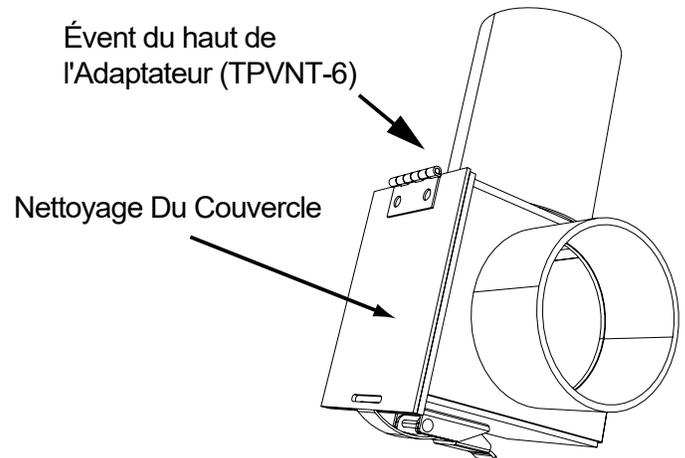
Figure 23.3 – 90° Adaptateur supérieur de ventilation arrière (TPVNT-6)
