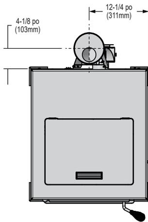
Figure 10.1 - Vue de dessus avec Évén du Haut de l'Adaptateur (TPVNT-5) et de 3 à 6 pouces de Décalage de l'Adaptateur (812-3570)
