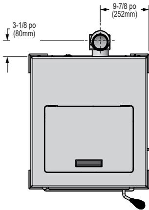
**Figure 11.1 - Vue de dessus avec Évent du Haut de l'Adaptateur (TPVNT-6) et de 3 à 4 pouces de Décalage de l'Adaptateur (811-0720)**
