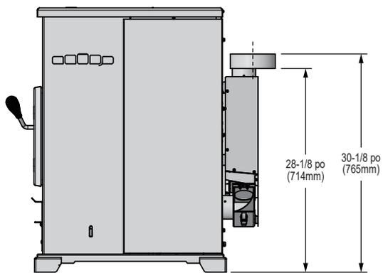
Figure 10.2 - Vue de côté avec Évén du Haut de l'Adaptateur (TPVNT-5) et de 3 à 6 pouces de Décalage de l'Adaptateur (812-3570)
