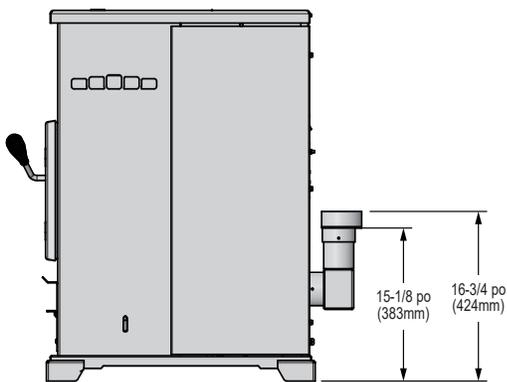
**Figure 11.2 - Vue de côté avec Évent du Haut de l'Adaptateur (TPVNT-6) et de 3 à 4 pouces de Décalage de l'Adaptateur (811-0720)**
