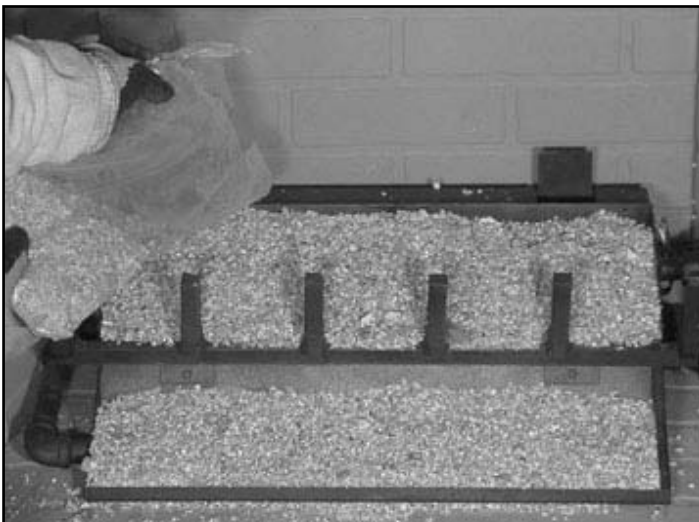
Figura 4 Colocación de la vermiculita
