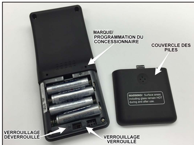
Figure 1. Installation des piles & sécurité des enfants
