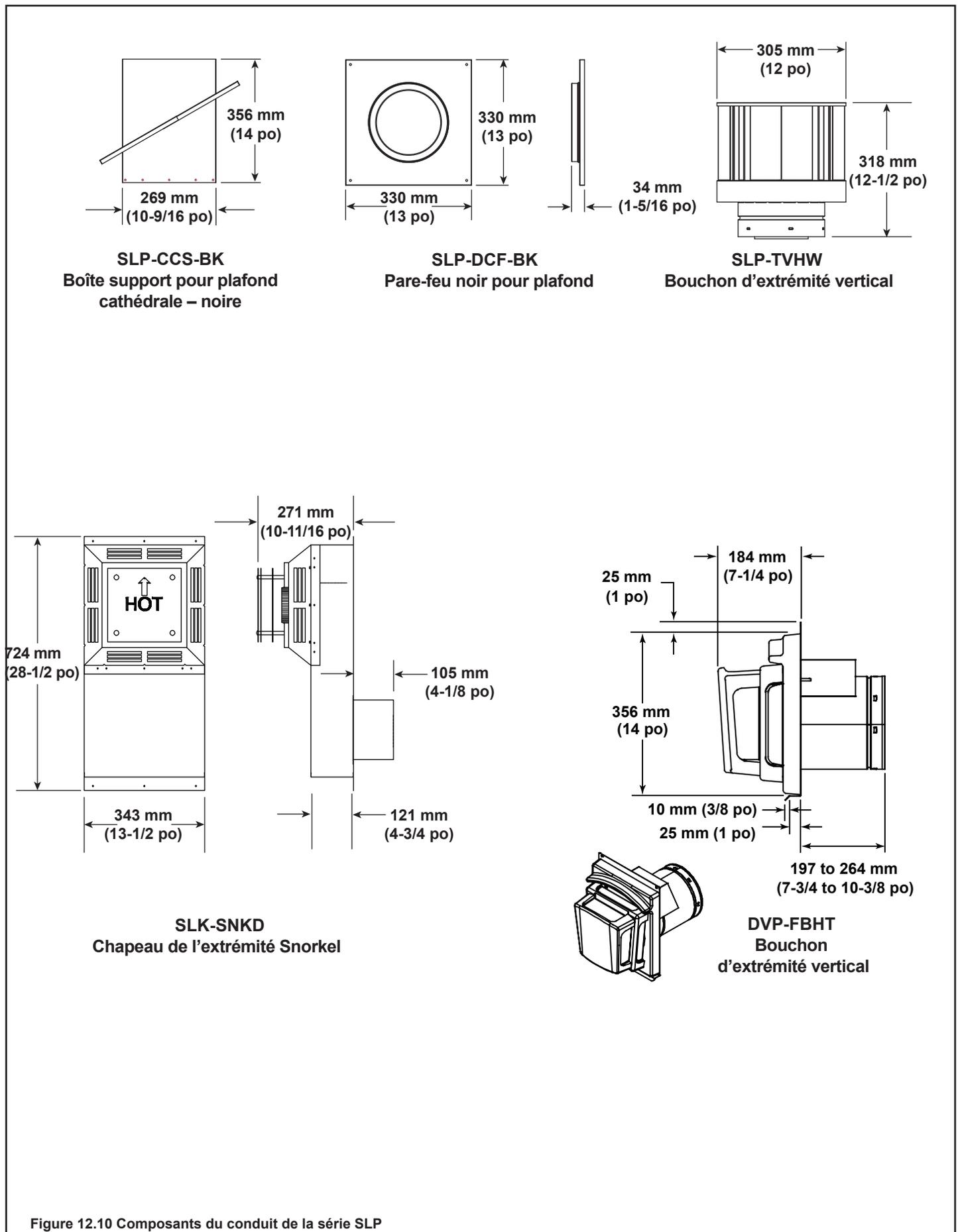
Figure 12.10 Composants du conduit de la série SLP
