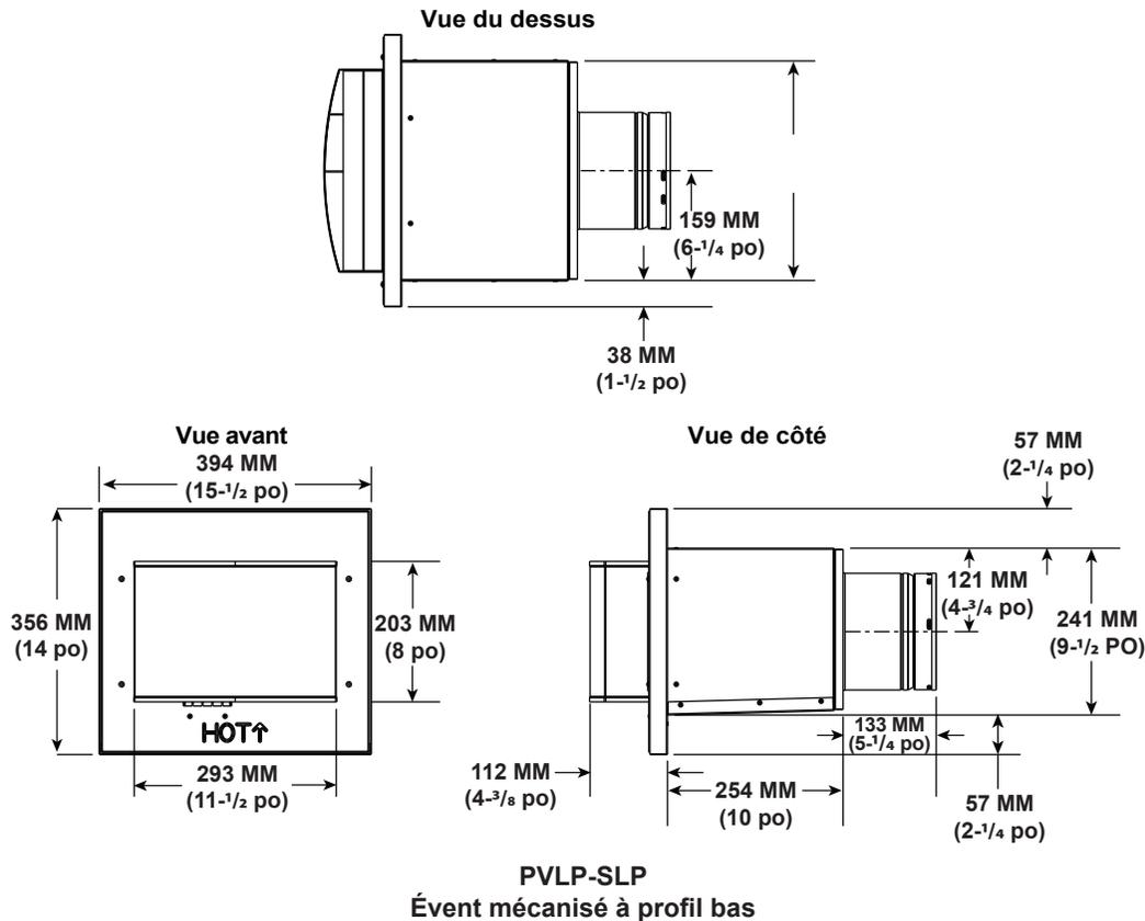
**Remarque :** Des faisceaux de câbles sont requis pour alimenter le PVLP-SLP branché à l'appareil et doivent être commandés indépendamment du PVLP-SLP. Communiquez avec votre détaillant pour commander.
