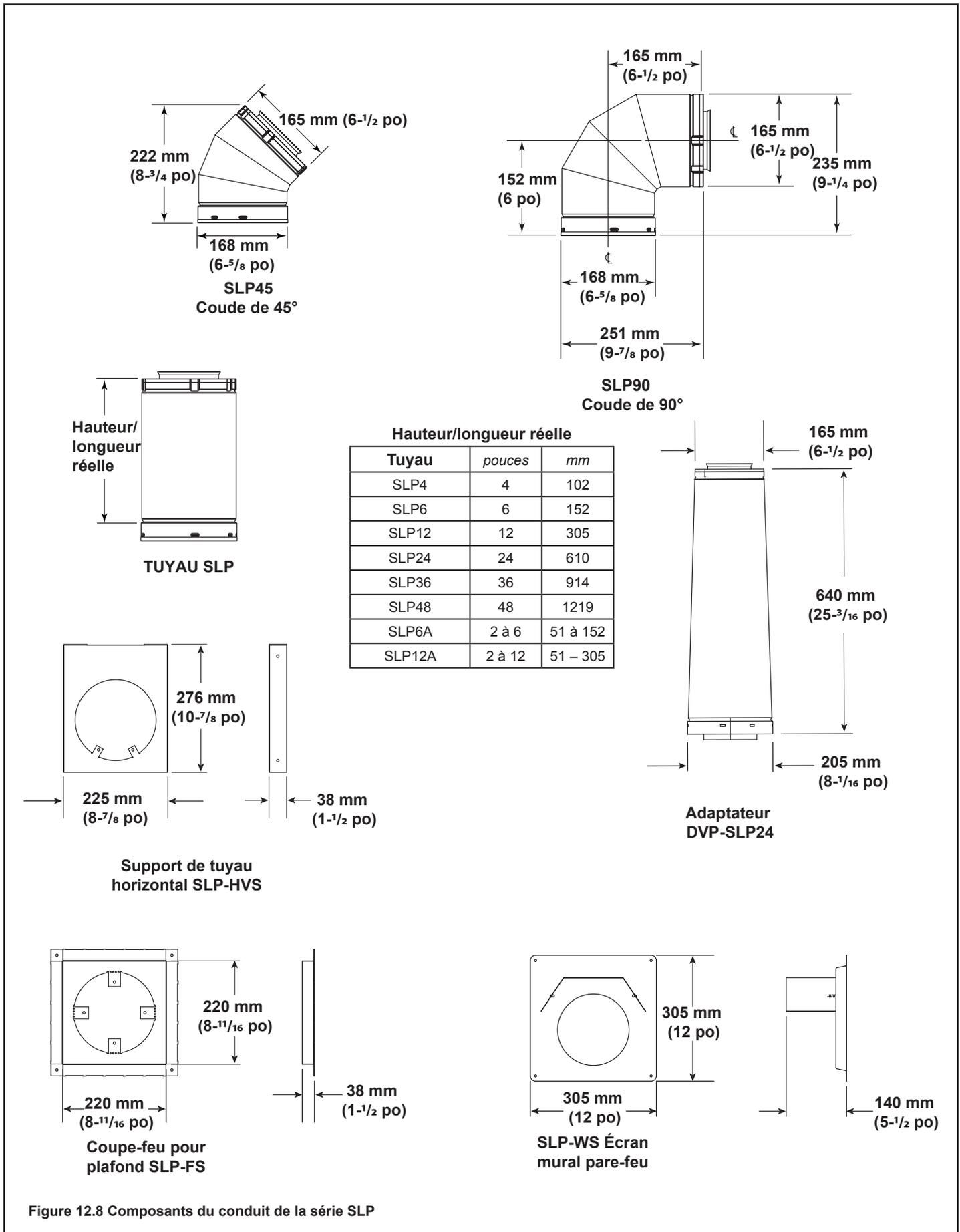
Figure 12.8 Composants du conduit de la série SLP
