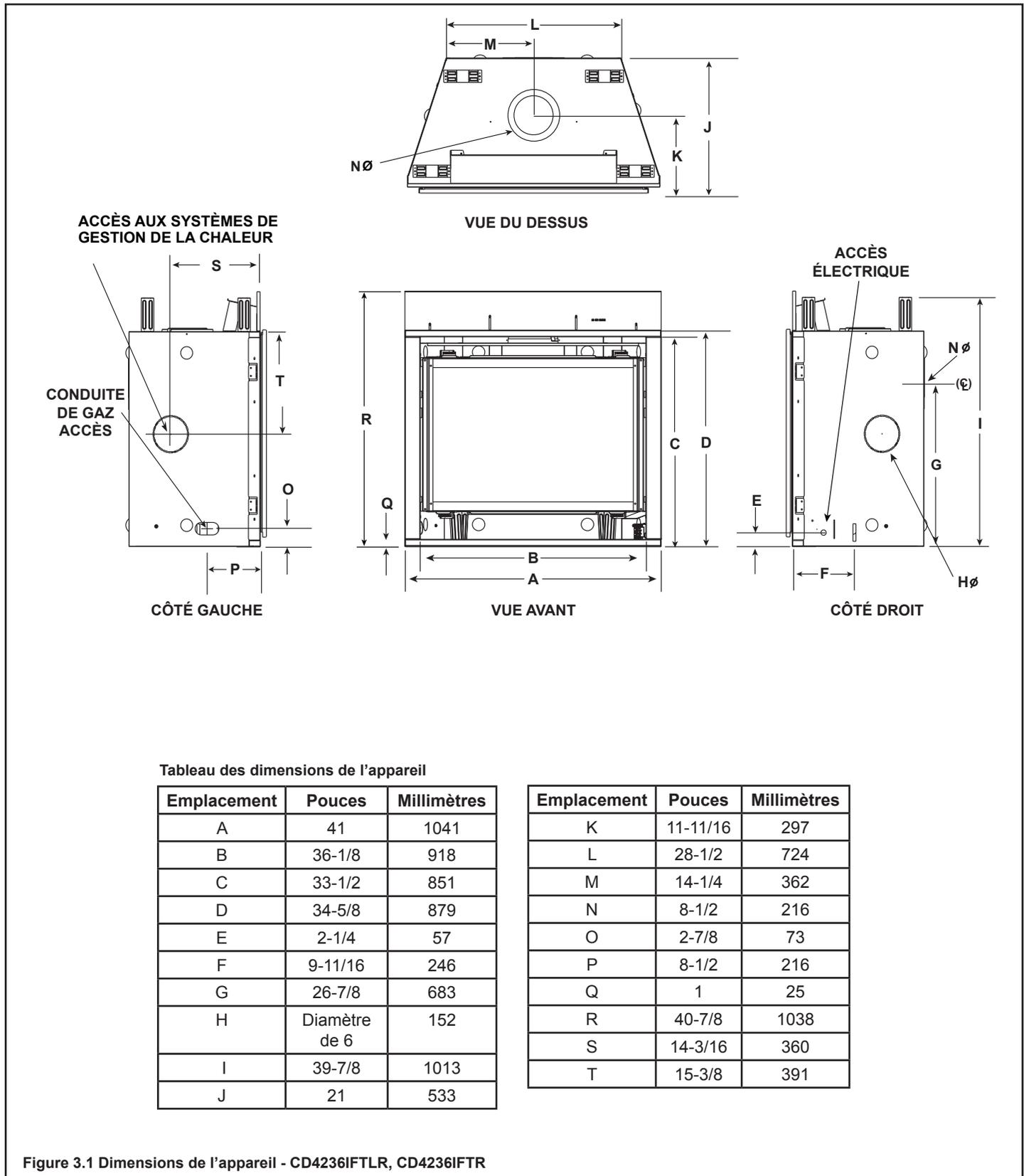
Figure 3.1 Dimensions de l'appareil - CD4236IFTLR, CD4236IFTR
