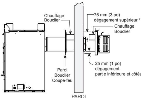
\* Avec des tuyaux SLP, les dégagements minimaux entre le conduit d'évacuation et les matériaux inflammables de l'intérieur du pare-feu mural sont : Haut : 64 mm (2-1/2 po) Bas : 13 mm (1/2 po) Côtés : 25 mm (1 po)
