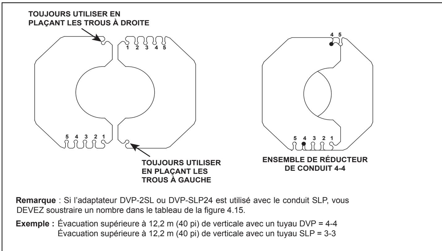
Figure 4.16 Mise en place du réducteur de conduit
