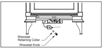
Figure 15 - Attach the fan rheostat.
