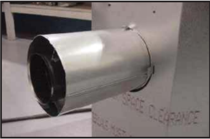
Figure 9.11 Fixez la première section d'évent (en s'encliquettera en place). Glissez le joint d'étanchéité d'isolant sur la section d'évent, contre le foyer et sur les pattes.
