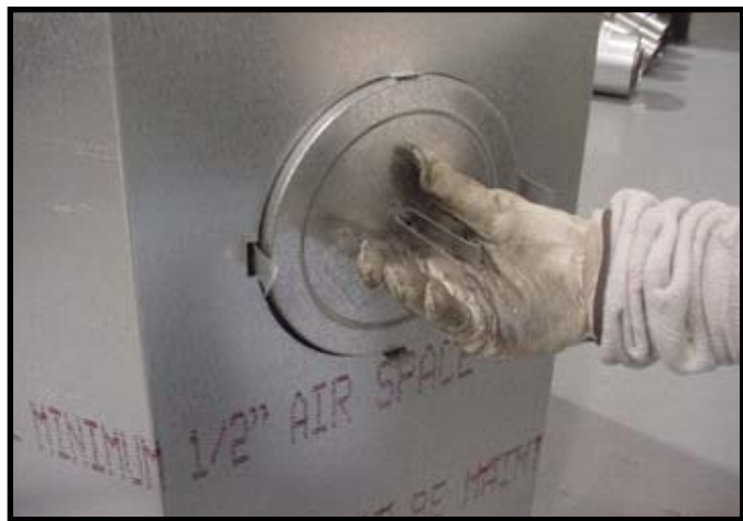
Figure 9.9 Repliez les parties centrales de la bande de retenue vers l'extérieur et utilisez cela pour retirer le capuchon plombé.
