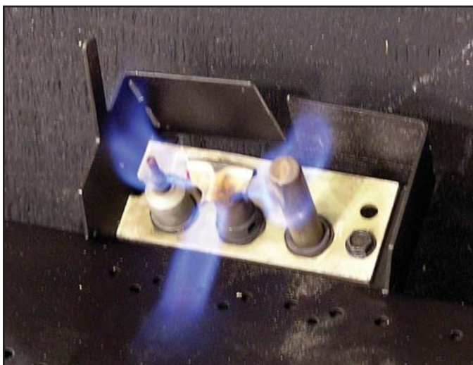
Figure 3.2 Forme de la flamme d'une veilleuse permanente
