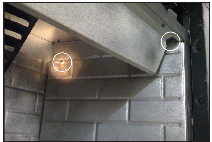
Figure 4.7 Vis du dessus du réfractaire métallique
