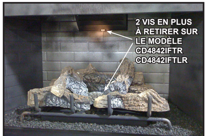
Figure 4.8 Vis supplémentaires du réfractaire métallique des modèles CD4842IFTR/CD4842IFTLR
