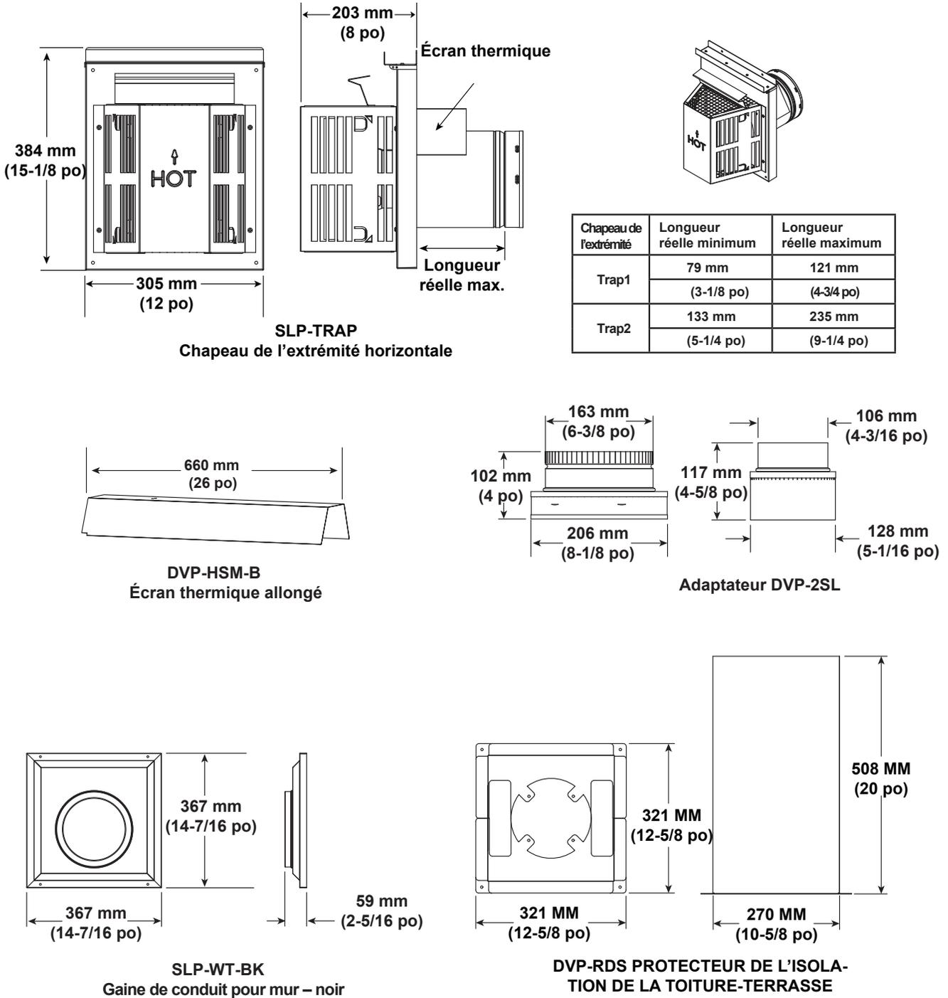
Figure 12.9 Composants du conduit de la série SLP
