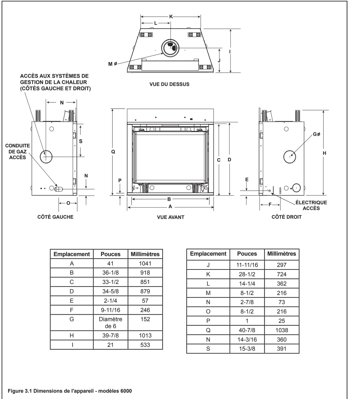
Figure 3.1 Dimensions de l'appareil - modèles 6000
