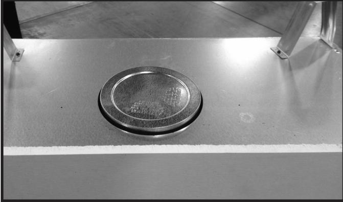
Figure 6.1. Couvercle d'étanchéité en position
