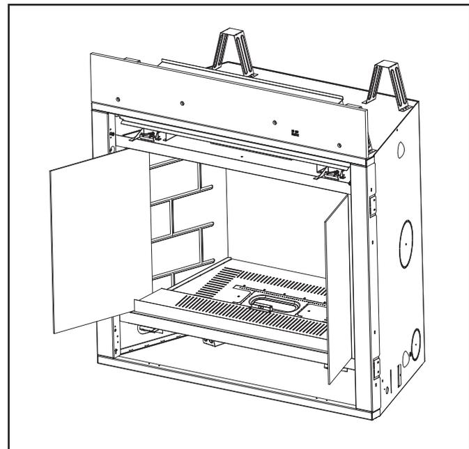
Figure 11.4 Installer les panneaux de verre latéraux
