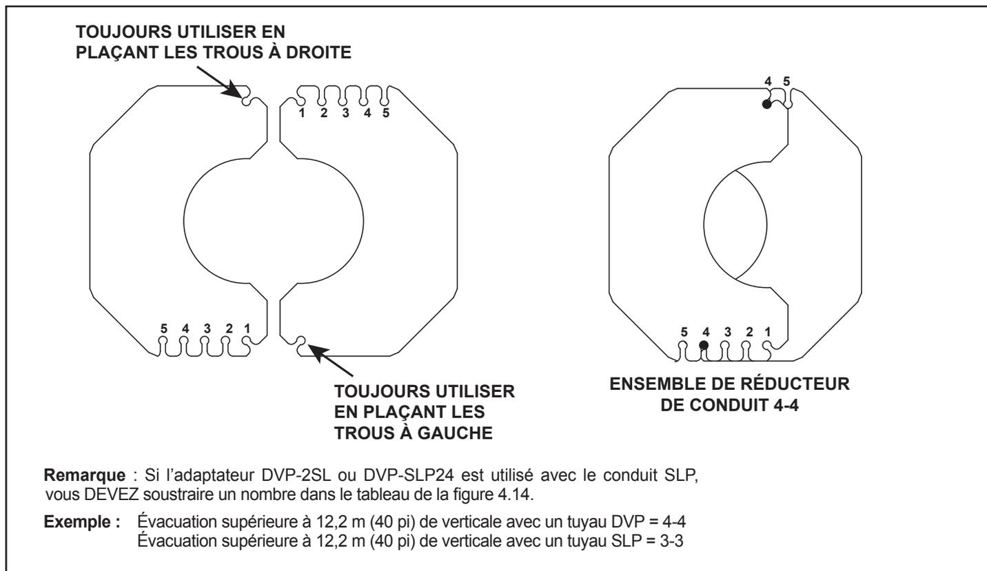
Figure 4.15 Mise en place du réducteur de conduit
