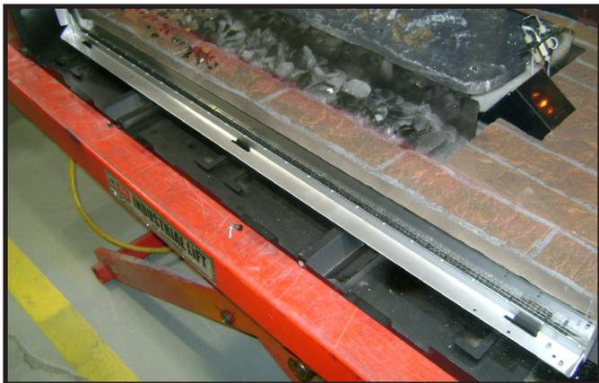
Figure 11.5 Onglets inférieurs de verrouillage installés dans le cadre de la vitre
