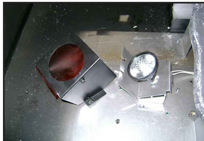
Figure 11.12 Retrait du boîtier de l'ampoule, ampoule installée
