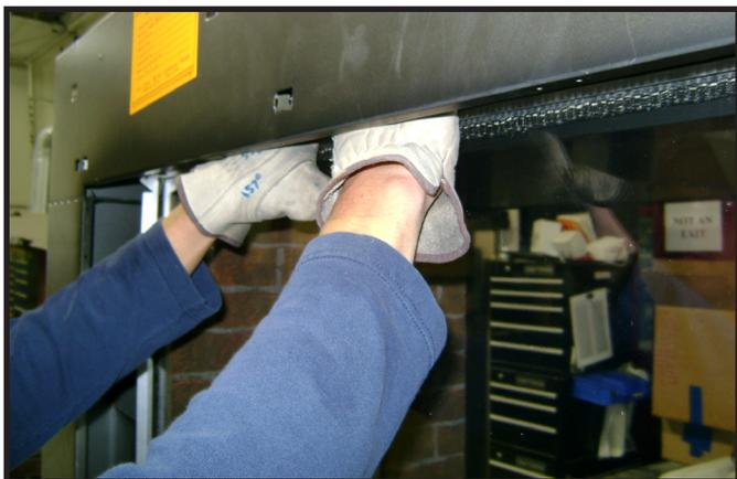
Figure 11.6 Accès à l'onglet supérieur de verrouillage
