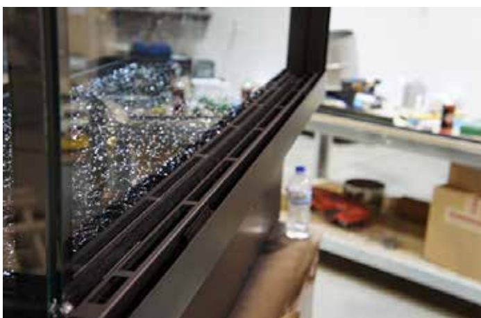
Figure 6B.4 - Pièce de garniture horizontale
