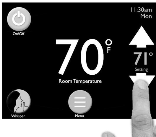
3. Utilisez les flèches pour régler la température de la pièce souhaitée.
