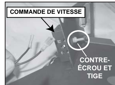
Figure 8.25 Déposez le bouton et le contre-écrou de la commande de vitesse. Installez la commande de vitesse dans le panneau de commande avec la tige sortant du trou prévu à cet effet. Serrez le contre-écrou et remettez le bouton sur la tige.
