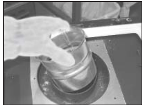
Figure 8.3 Enlevez le collier adaptateur intérieur
