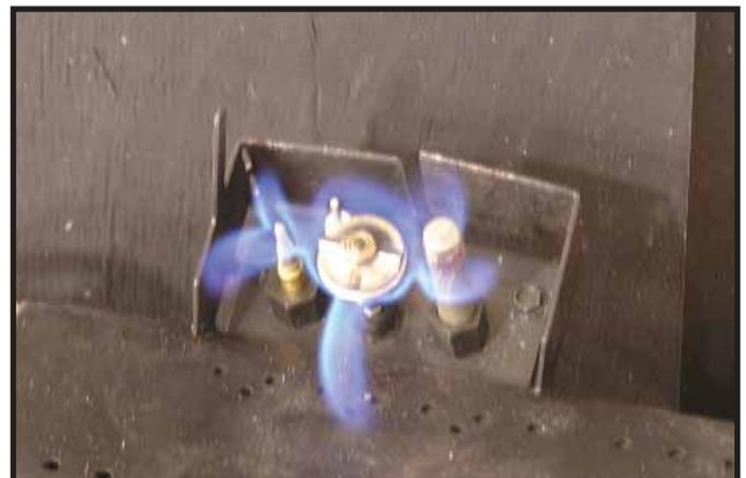
Figure 3.1 Modèles de flamme de veille permanente
