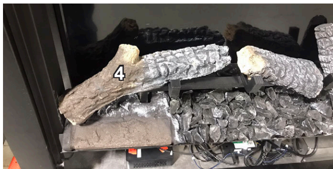
Figure 4.26 Installation de la bûche n° 4
