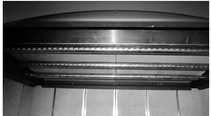
Figure 4.8 Réinstaller les panneaux de déflecteur
