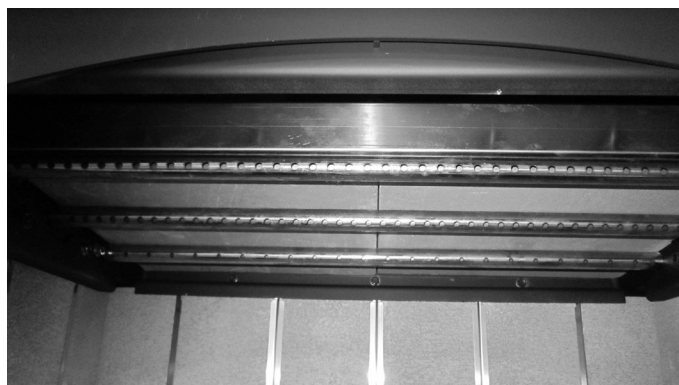
Figure 4.8 Réinstaller les panneaux de déflecteur
