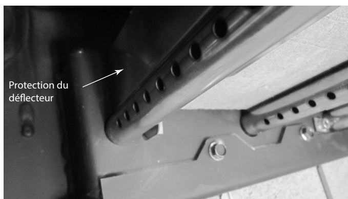
Figure 4.9 Réinstaller le canal de protection du déflecteur
