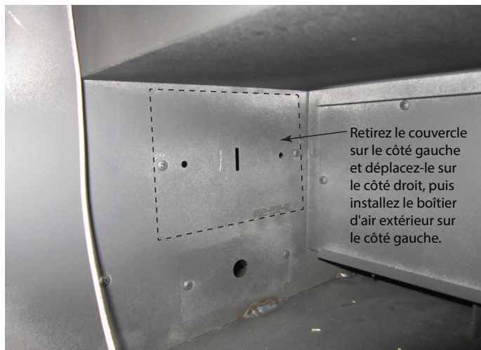
Figure 3.14 Retirer le couvercle (côté gauche)
