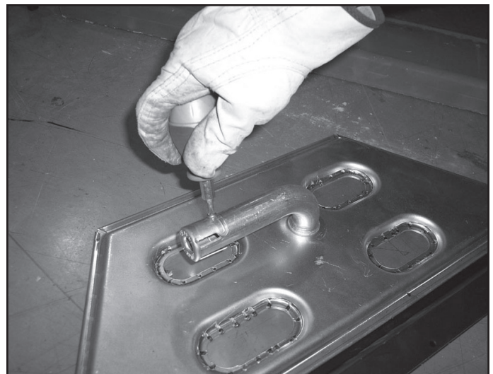
Figure 14.31 Régler l'obturateur d'air
