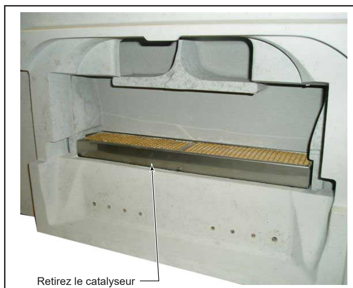
Figure 3.12 – Retrait du catalyseur.
