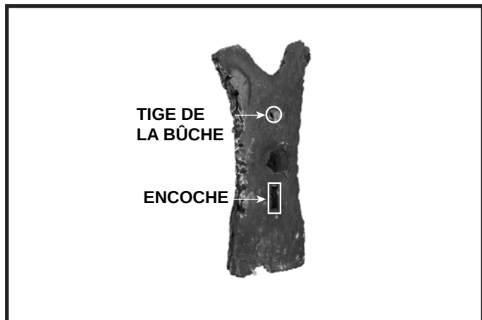
Figure 12 Bûche n°6 Trou de le broche et fente
