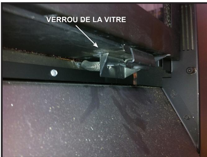
Figure 9.6 Assemblage de la vitre - Côté extérieur
