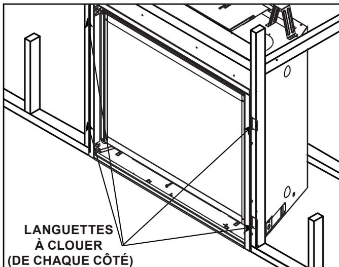
Figure 6.5 Positionnement et fixation adéquate de l'appareil
