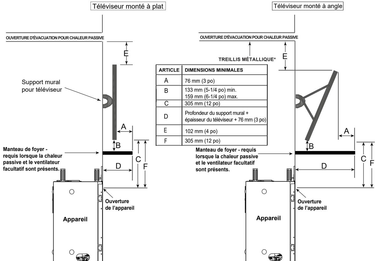
\* L'écran à mailles est requis pour les installations d'évacuation/d'échappement avant ou d'échappement en haut pour la chaleur passive avec une ouverture d'évacuation d'au moins 76 mm (3 po) ou plus.
