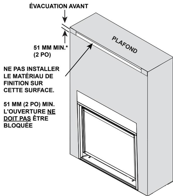
\* = L'écran à mailles est requis pour les installations d'évacuation/d'échappement avant ou d'échappement en haut pour la chaleur passive avec une ouverture d'évacuation de 76 mm (3 po) ou plus.
