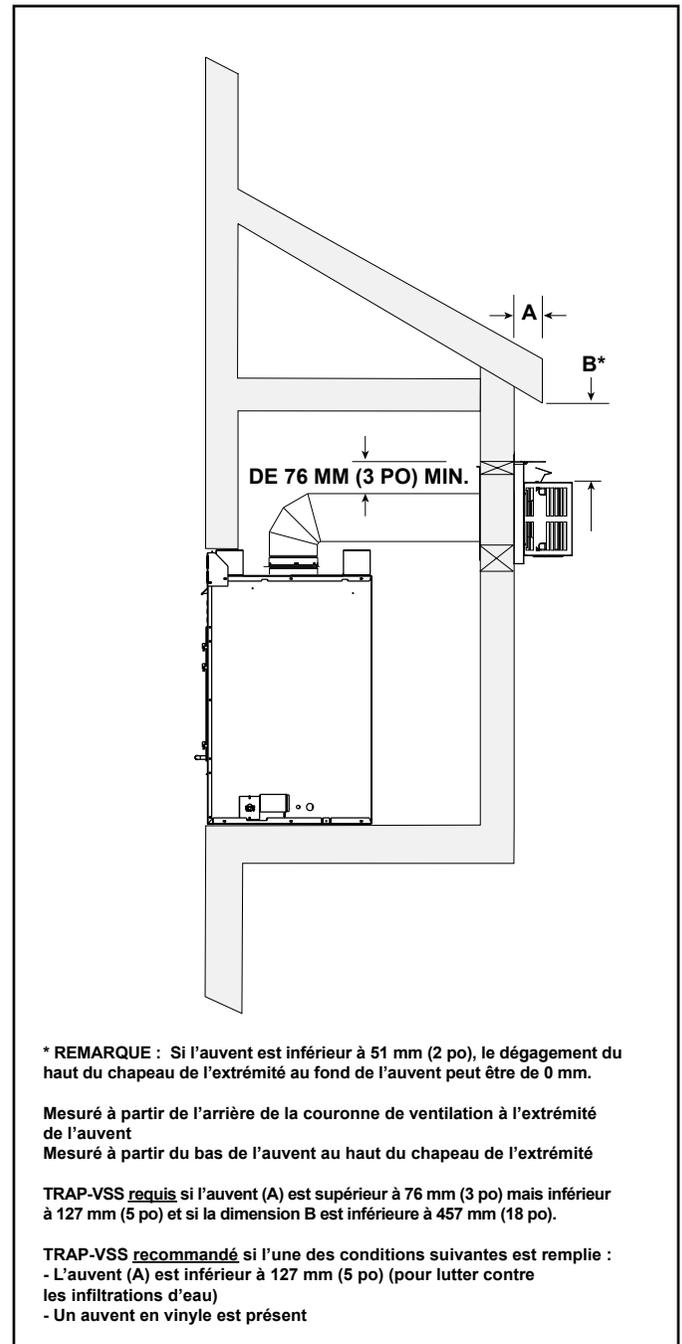
Figure 3.14 Enchâssure extérieure - Exigences minimales de hauteur
