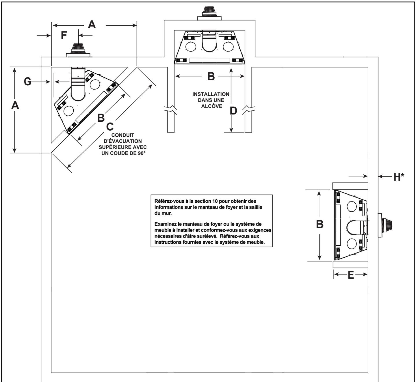
H\* = Lorsque le mur extérieur est construit en 2 x 4, un chapeau de l'extrémité d'une longueur réelle égale à celle du DVP-TRAP1 est nécessaire. Voir la figure 3.9.
