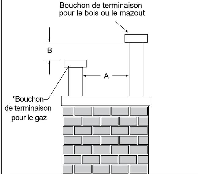
\* S'il y a deux extrémités de gaz, ils peuvent être au même niveau (B = 0 mm) à condition que A soit d'au moins 152,4 mm.
