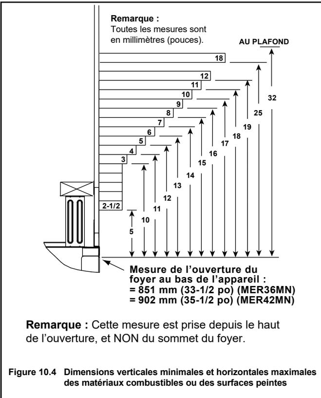
Figure 10.4 Dimensions verticales minimales et horizontales maximales des matériaux combustibles ou des surfaces peintes
