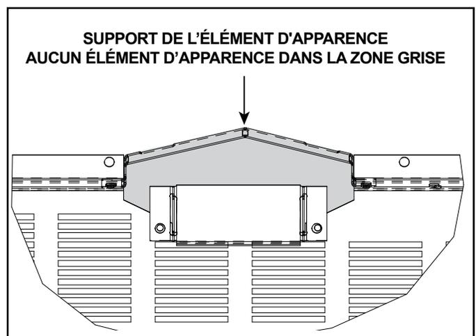
Figure 11.4 Disposition du support des éléments d'apparence
