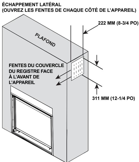
Figure 10.10 Matériau de finition installé avec le système optionnel de gestion de la chaleur passive
