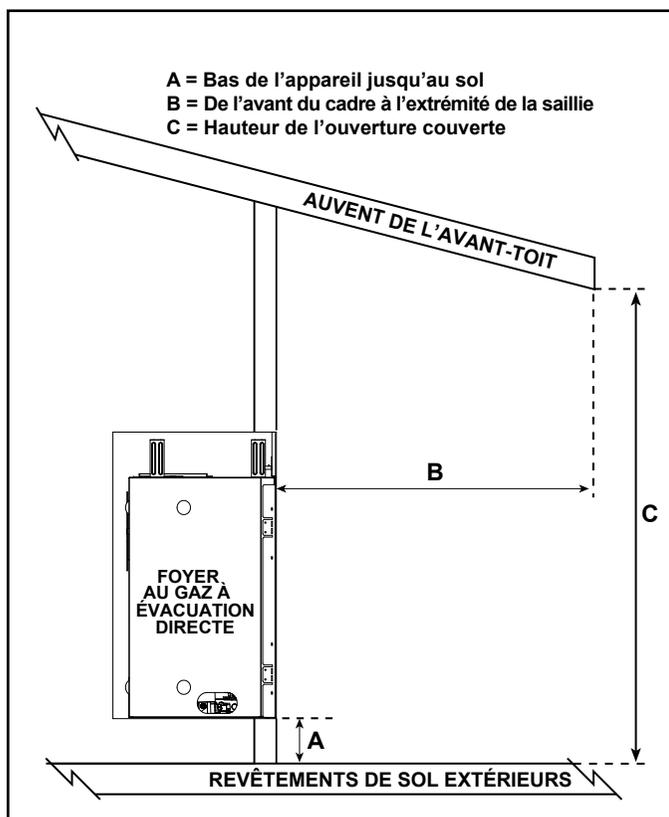
Figure 3.7 Applications extérieures protégées - Dimensions
