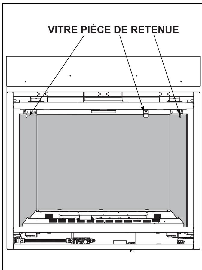
Figure 11.2 Retenue de la vitre en position
