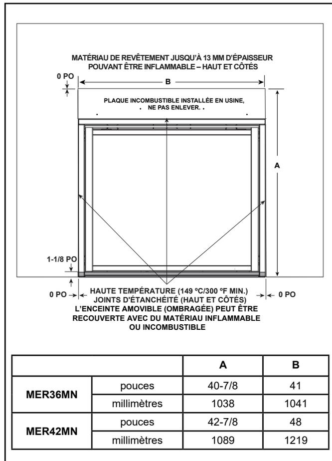
Figure 10.2 Schéma du revêtement incombustible
