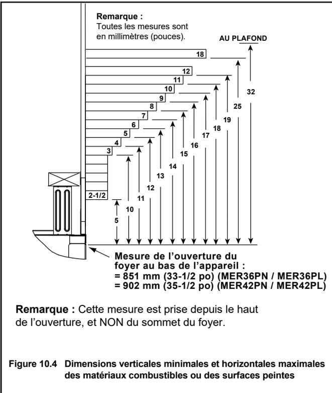
Figure 10.4 Dimensions verticales minimales et horizontales maximales des matériaux combustibles ou des surfaces peintes
