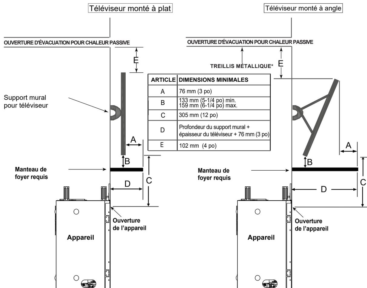
\* L'écran à mailles est requis pour les installations d'évacuation/d'échappement avant ou d'échappement en haut pour la chaleur passive avec une ouverture d'évacuation d'au moins 76 mm (3 po) ou plus.
