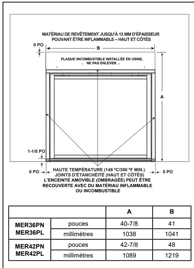
Figure 10.2 Schéma du revêtement incombustible
