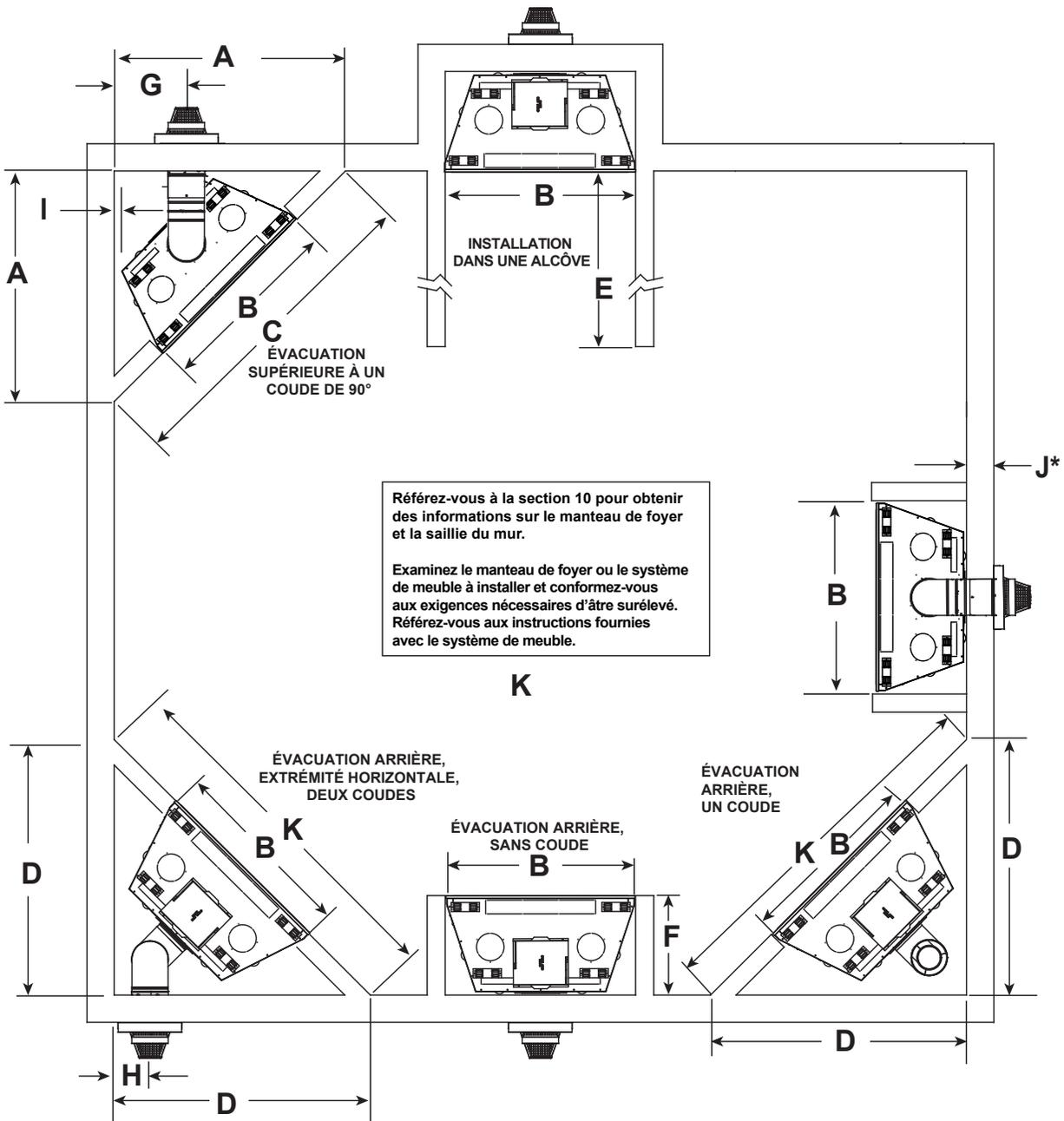
J\* = Lorsque le mur extérieur est construit en 2 x 4, un chapeau de l'extrémité d'une longueur réelle égale à celle du DVP-TRAP1 est nécessaire. Voir la figure 3.9.
