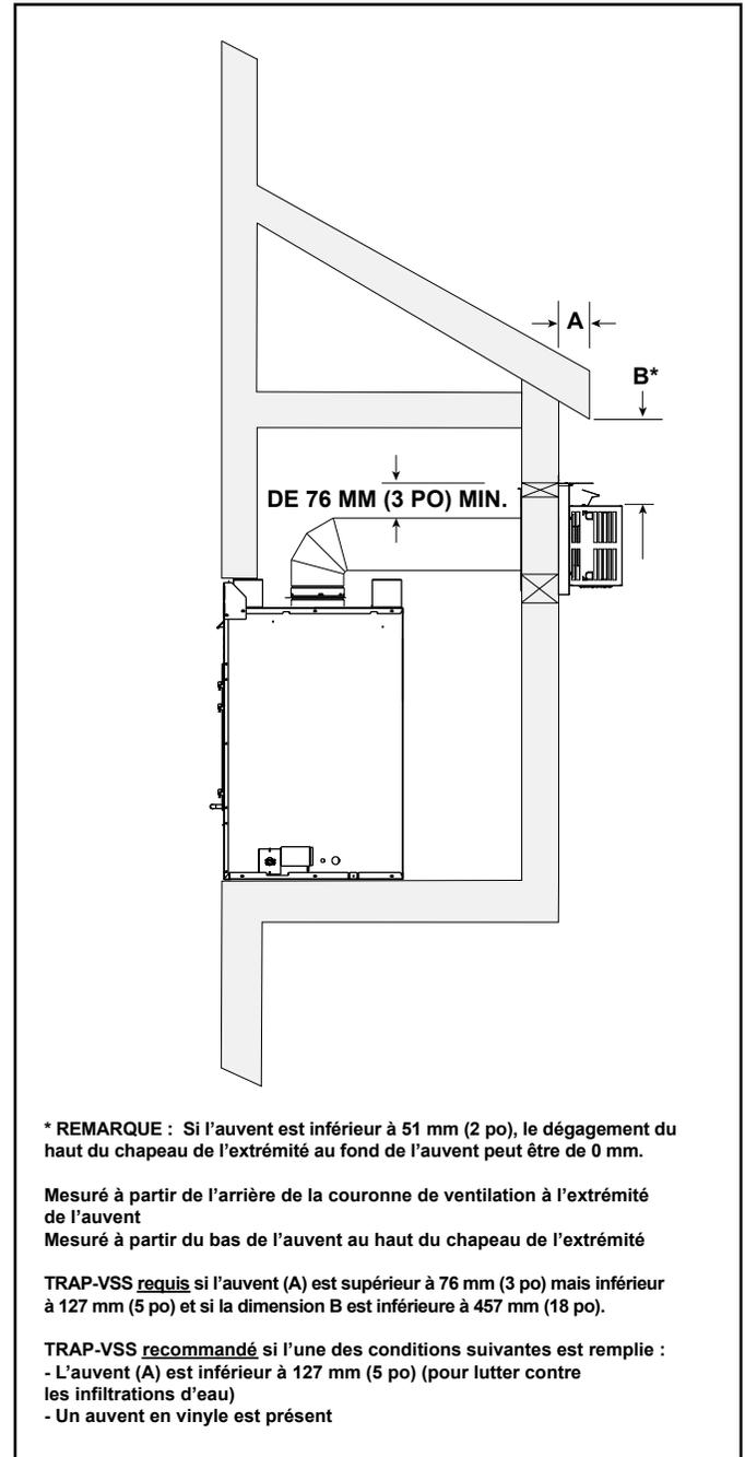
Figure 3.14 Enchâssure extérieure - Exigences minimales de hauteur
