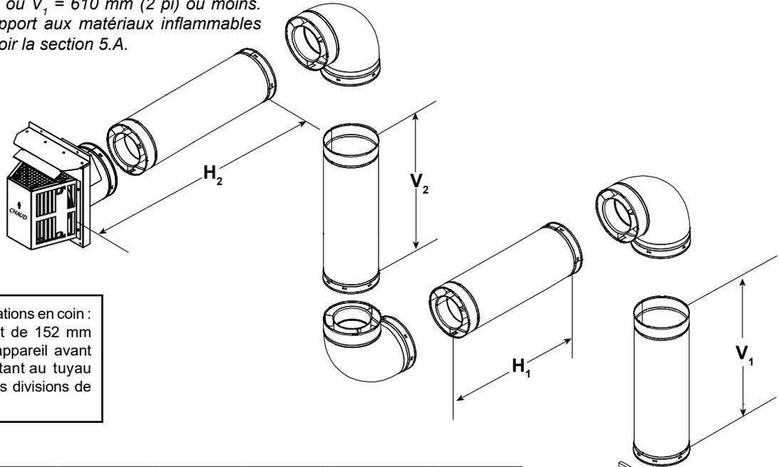
**Remarque :** Pour les installations en coin : Une section de tuyau droit de 152 mm (6 po) peut être fixée à l'appareil avant un coude de 90°, permettant au tuyau d'évacuation de dégager les divisions de sécurité sur l'appareil.
