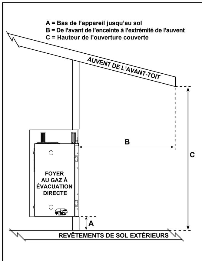
Figure 3.7 Applications extérieures protégées - Dimensions
