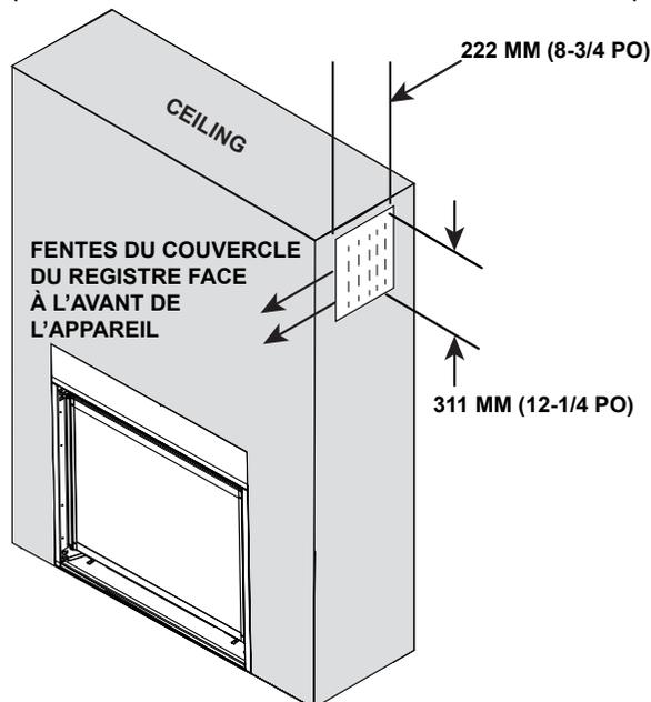
Figure 10.10 Matériau de finition installé avec le système optionnel de gestion de la chaleur passive
