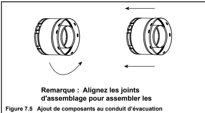
**AVIS :** Lors de l'installation d'un système de conduit d'évacuation avec un chapeau de l'extrémité HRC, tous les joints du système doivent être scellés en utilisant un agent d'étanchéité à base de silicone pour hautes températures (degré minimum d'exposition continue de 150 °C [300 °F]).
