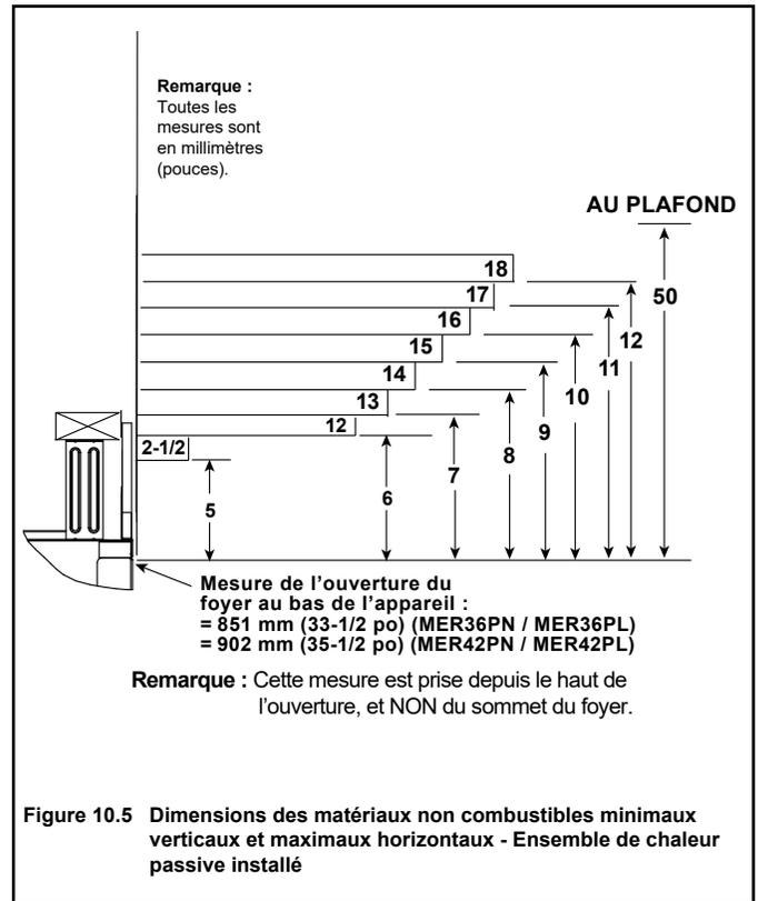
Figure 10.5 Dimensions des matériaux non combustibles minimaux verticaux et maximaux horizontaux - Ensemble de chaleur passive installé
