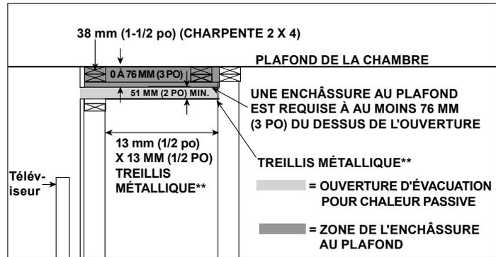
**AVERTISSEMENT! Risque d'incendie!** Le treillis métallique est requis au bas (fond) de l'ouverture d'échappement (Dimension A) lorsque l'ouverture d'évacuation finie est supérieure à 76 mm (3 po). Fixez le treillis métallique au dessus de la charpente.
