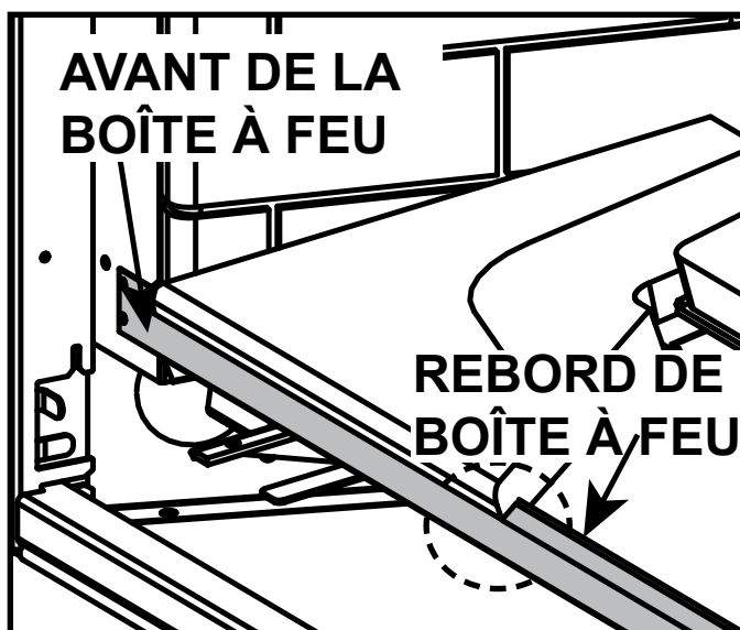
Figure 11.9 Réfractaire de base avant installé
