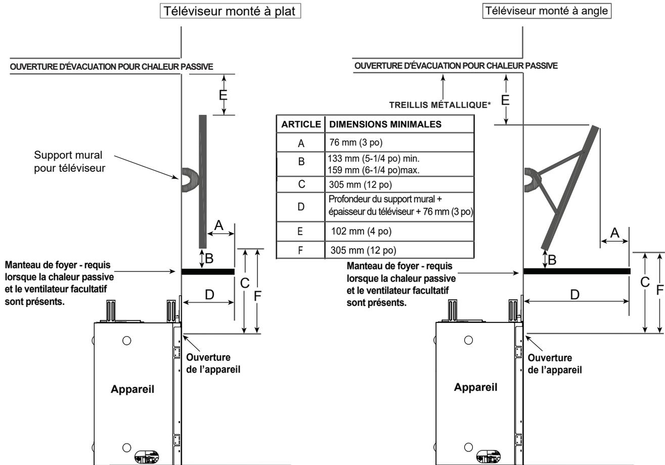
\* L'écran à mailles est requis pour les installations d'évacuation/d'échappement avant ou d'échappement en haut pour la chaleur passive avec une ouverture d'évacuation d'au moins 76 mm ou plus.
