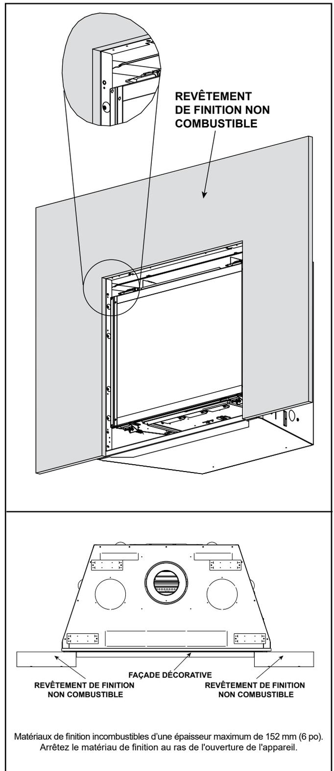
Figure 10.11 Méthode d'ajustement intérieur
