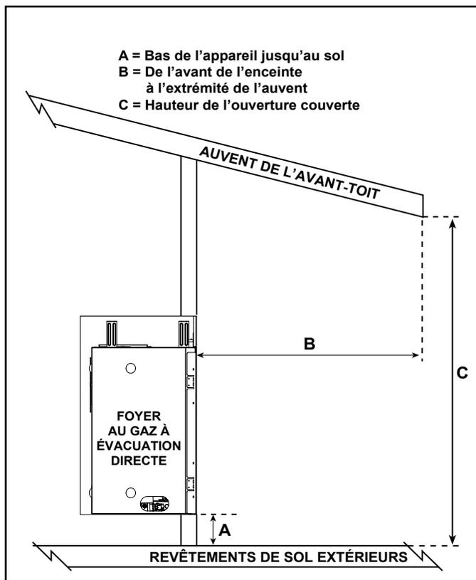
Figure 3.6 Applications extérieures protégées - Dimensions
