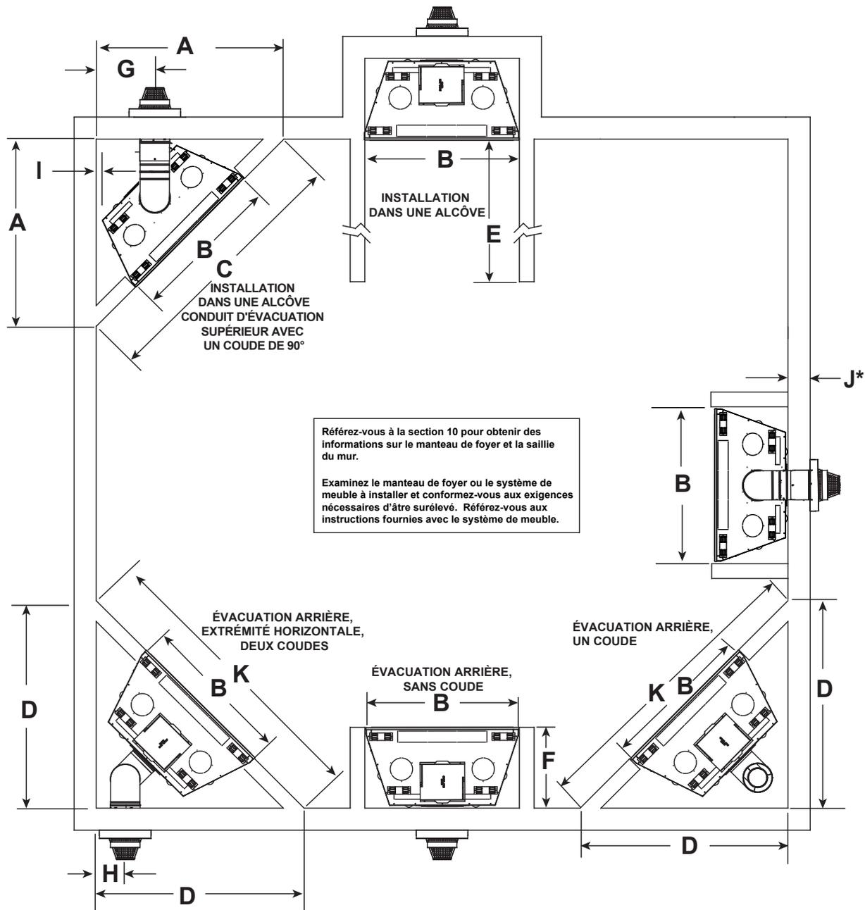
J\* = Lorsque le mur extérieur est construit en 2 x 4, un chapeau de l'extrémité d'une longueur réelle égale à celle du DVP-TRAP1 est nécessaire. Voir la figure 3.8.
