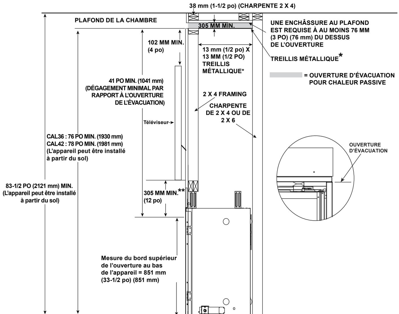
\* Le treillis métallique est requis pour les installations d'évacuation/d'échappement avant ou d'échappement en haut pour la chaleur passive avec une ouverture d'évacuation d'au moins 76 mm (3 po) ou plus.
