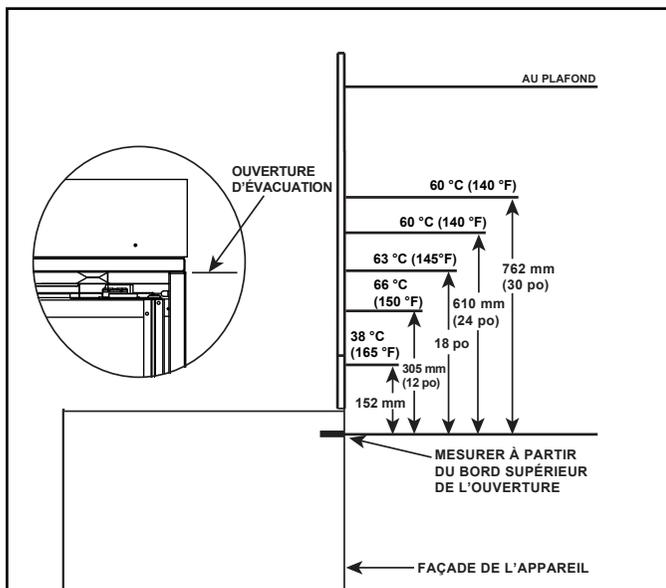
Figure 2.1 Températures de la surface du mur au-dessus de l'appareil
