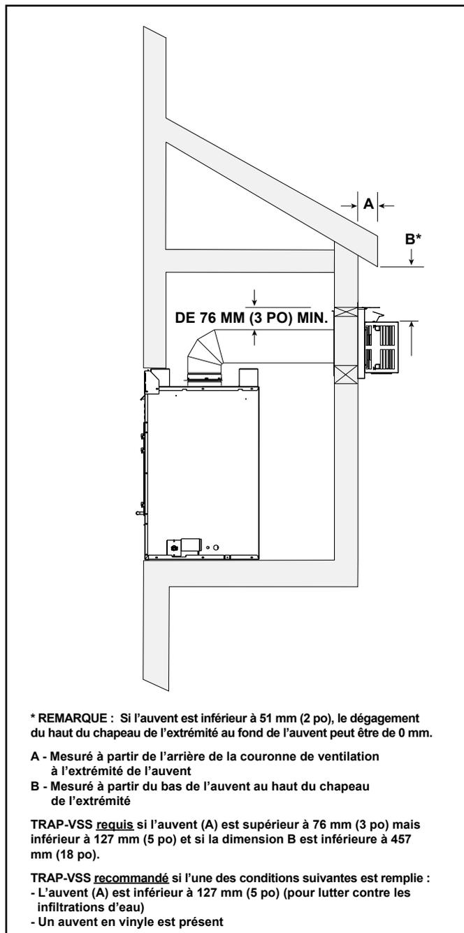
Figure 3.13 Enchâssure extérieure - Exigences minimales de hauteur
