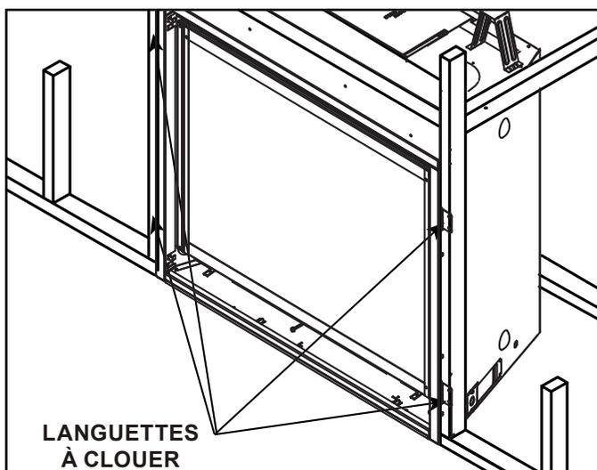
Figure 6.13 Positionnement et fixation adéquate de l'appareil
