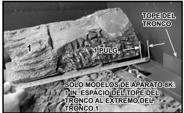
Figura 3.B Distancia del tronco 1 al tope del tronco (solo modelos de aparato 8K)
