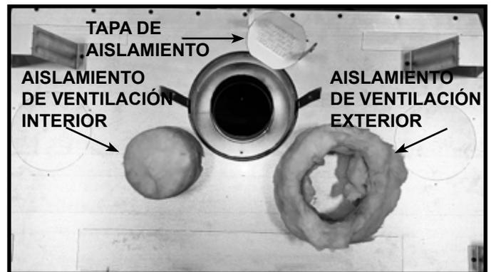
Figura 6.5 Retiro de tapa de aislamiento, aislamiento de ventilación interior y aislamiento de ventilación exterior
