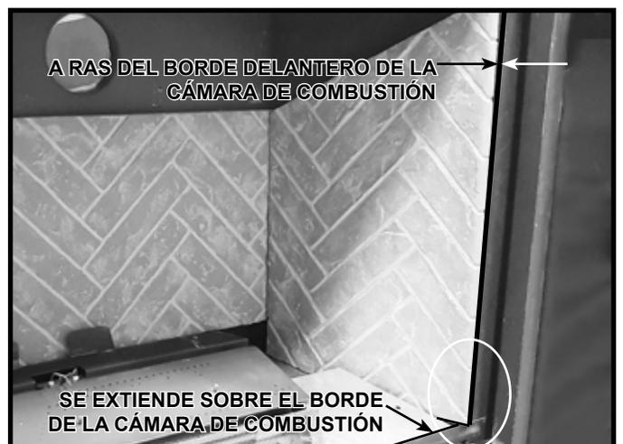
Figura 11.4 Instalación del panel refractario lateral (se muestra el lado derecho)
