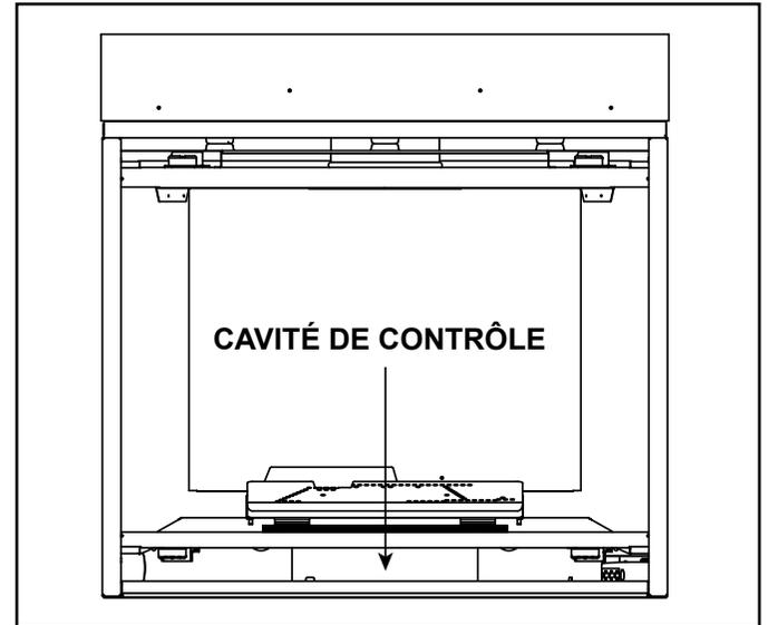
3.3 Cavité des commandes / Emplacement du bloc-piles
