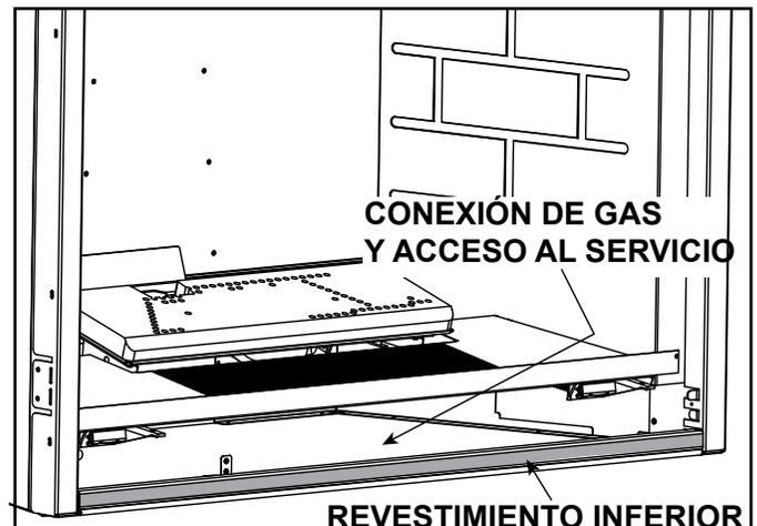
Figura 9.1 Retiro del revestimiento inferior
