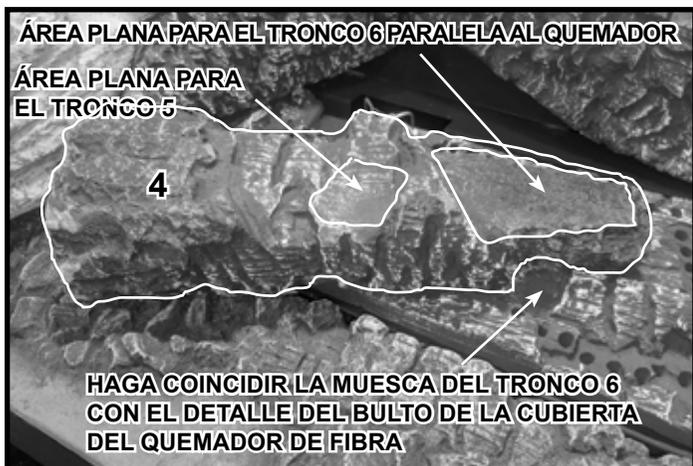
Figura 7 Colocación del tronco 4
