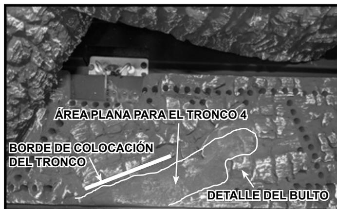
Figura 8 Detalles de colocación del tronco
