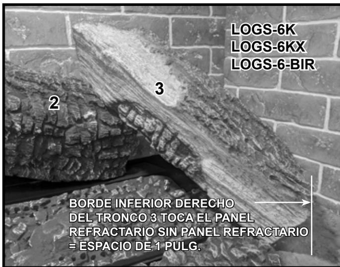
Figura 5.B Colocación del tronco 3 (LOGS-6K/LOGS-6KX/LOGS-6-BIR)
