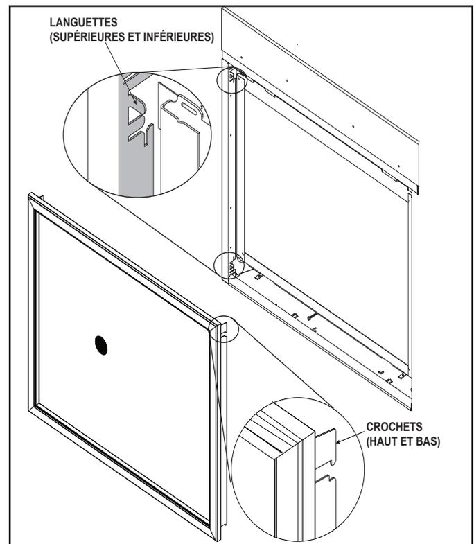
Figure 7 Emplacement de la languette de suspension et des crochets
