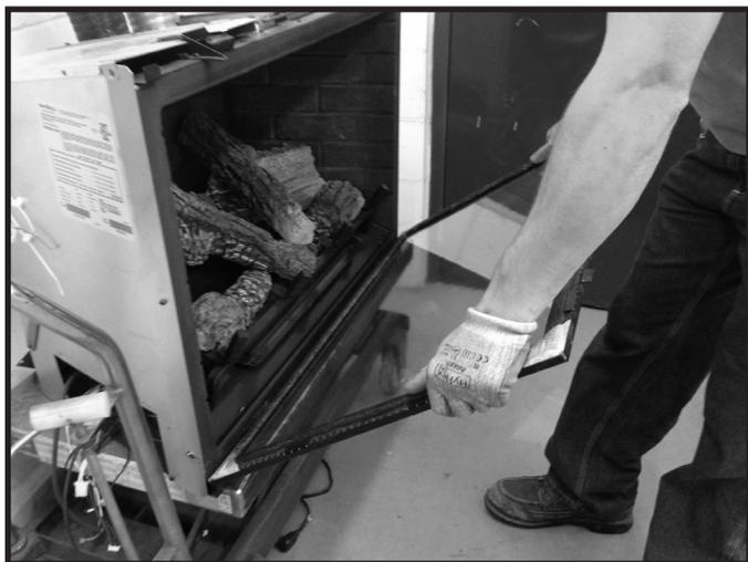
Figure 4.4 Incliner la vitre vers le bas et soulever pour dégager le verrou du bas.
