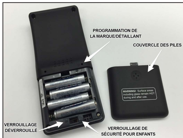
Figure 1. Installation des piles et sécurité pour enfant
