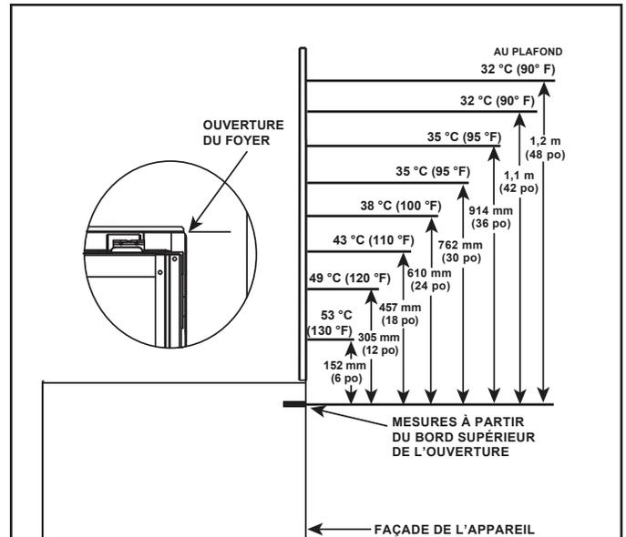
Figure 3.3. Températures de la paroi en-dessus de l'appareil
