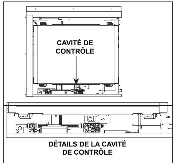
3.5 Emplacement de la cavité de contrôle (PIER-36TR-IFT illustré)
