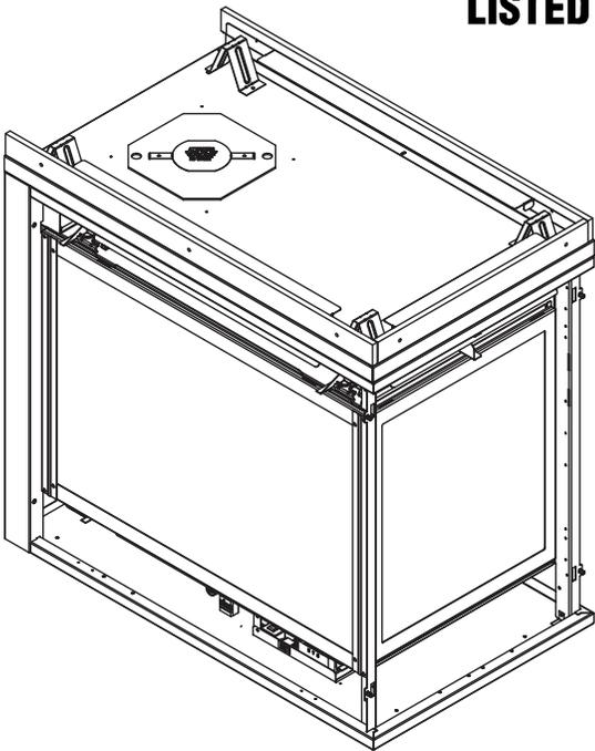
Cet appareil peut être installé en tant qu'équipement d'origine dans une maison préfabriquée (États-Unis seulement) ou maison mobile. Il doit être installé en conformité avec les instructions du fabricant et les *Manufactured Home Construction and Safety Standard, Title 24 CFR, Part 3280* aux États-Unis, ou les *normes d'installation pour maisons mobiles, CAN/CSA Z240 Séries MH*, au Canada.
