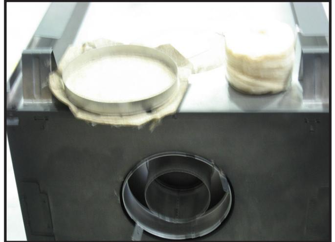
**Figure 6.8** Jetez le couvercle du conduit, le bouchon d'isolation et le panier d'isolation.
