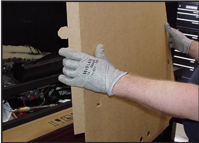
Figure 11.4 Plier les côtés droit et gauche de l'anti-projection
