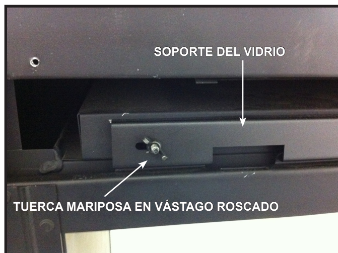
9.2 Detalle del conjunto de vidrio - Lado interior
