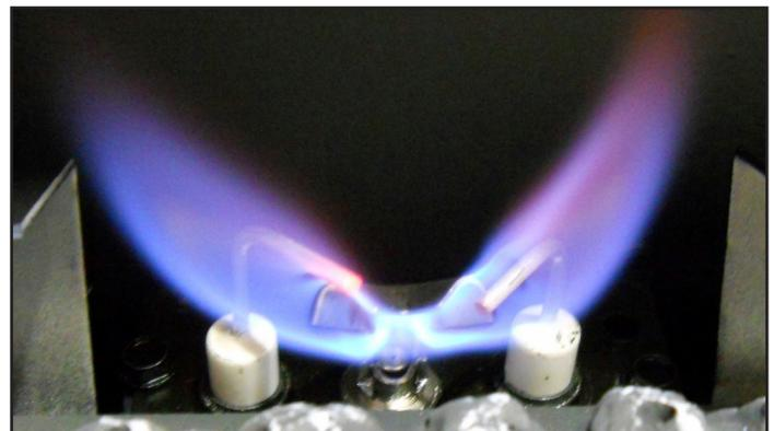
Figure 4.3 Forme de flamme de la veilleuse IPI
