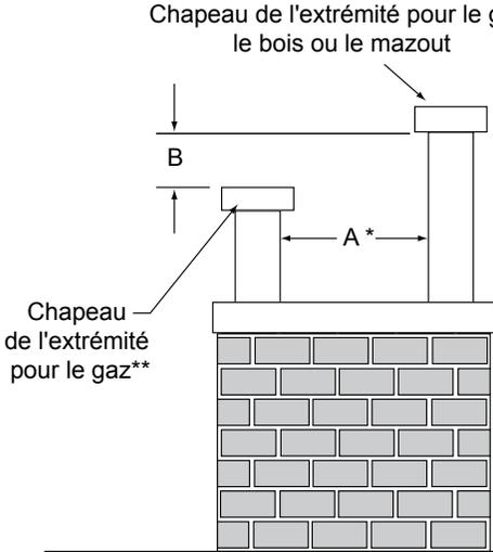
\* Si un couvercle d'extrémité décoratif est utilisé, la distance pourrait devoir être augmentée. Se reporter aux instructions d'installation fournies avec le couvercle d'extrémité décoratif.
