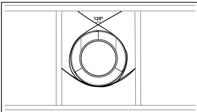
Figure 7.6 Fixation des sections horizontales du conduit
