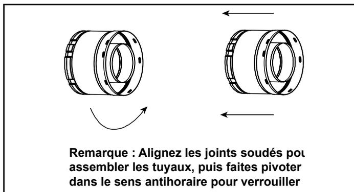
**Remarque :** Alignez les joints soudés pour assembler les tuyaux, puis faites pivoter dans le sens antihoraire pour verrouiller
