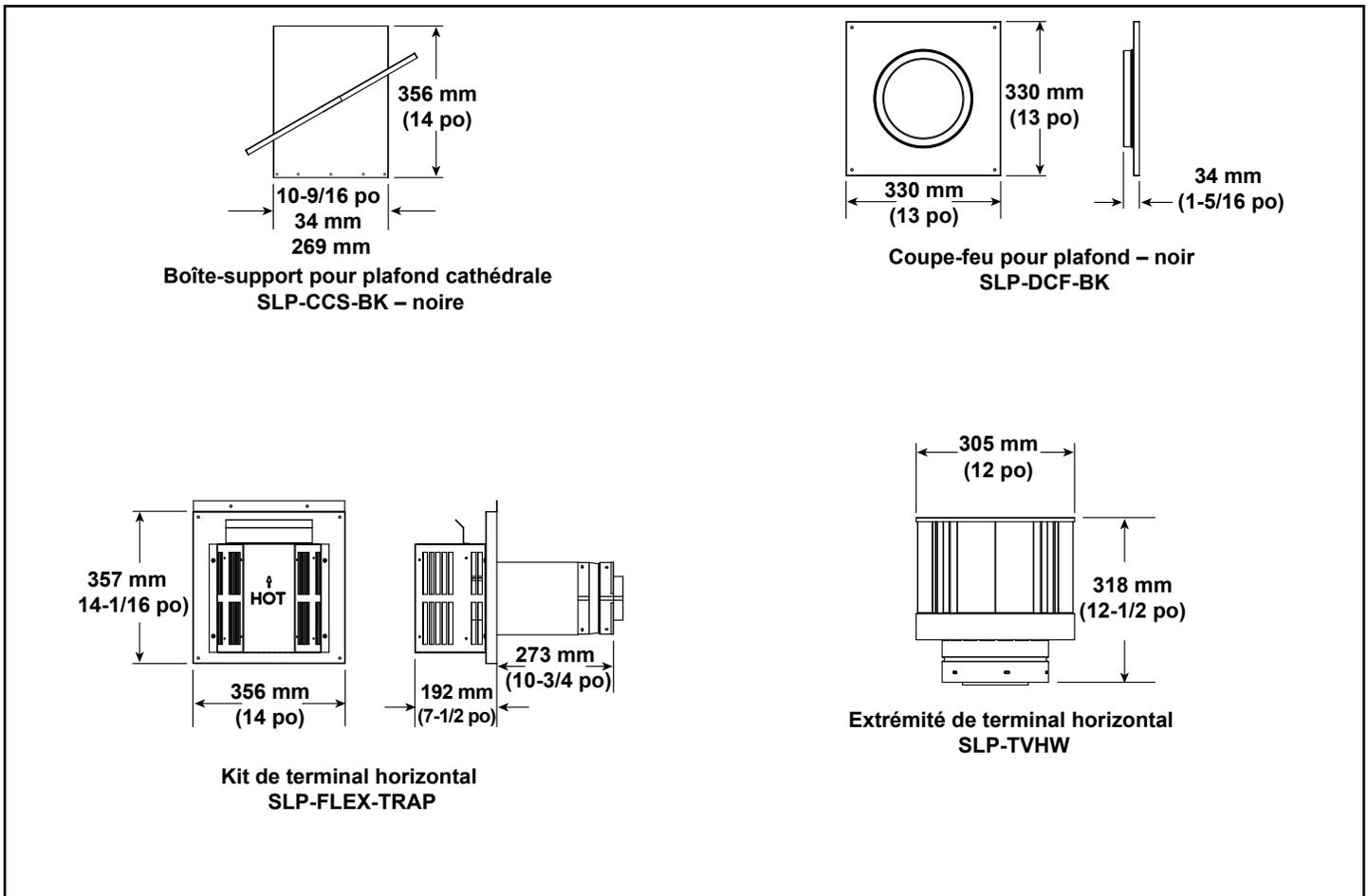
Figure 11.3 Composants du conduit de la série SLP
