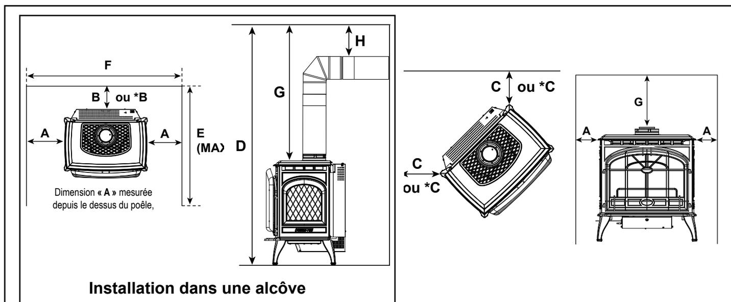
**Remarque :** Les dimensions telles que montrées sont des minimums et pourraient ne pas s'appliquer à toutes les installations. Une installation en alcôve est présentée ci-dessus, à gauche.
