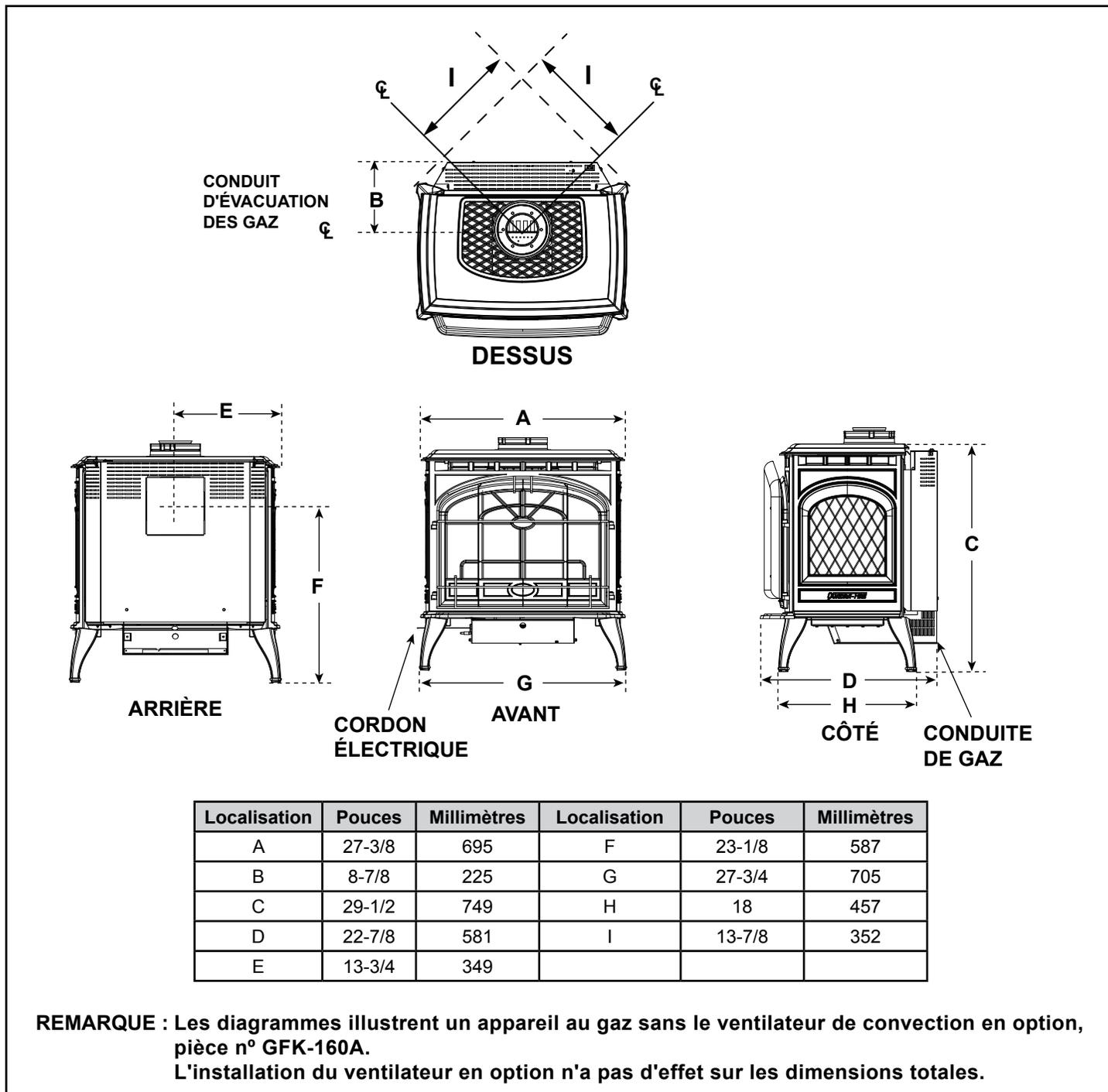
Figure 3.1 Dimensions de l'appareil
