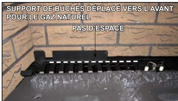
Figure 10.10 Position du support de bûches - gaz naturel
