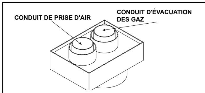
Figure 4.29 Connecteur de poêle coaxial/colinéaire
