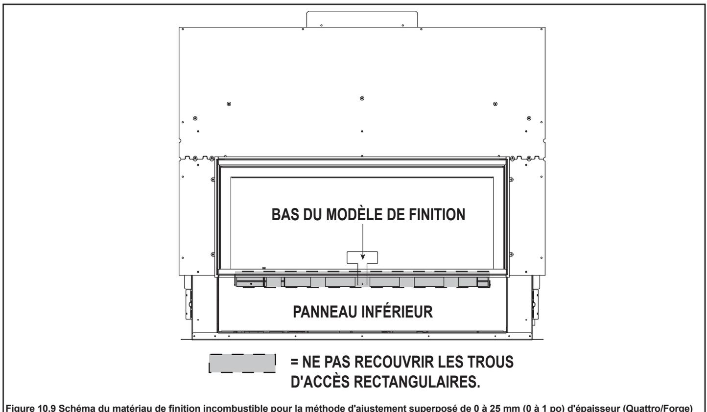
**AVERTISSEMENT! Risque d'incendie! NE PAS** appliquer de matériaux inflammables au-delà des dégagements minimaux. Respectez tous les dégagements minimaux spécifiés dans ce manuel pour les matériaux inflammables. Les matériaux superposés pourraient s'enflammer.
