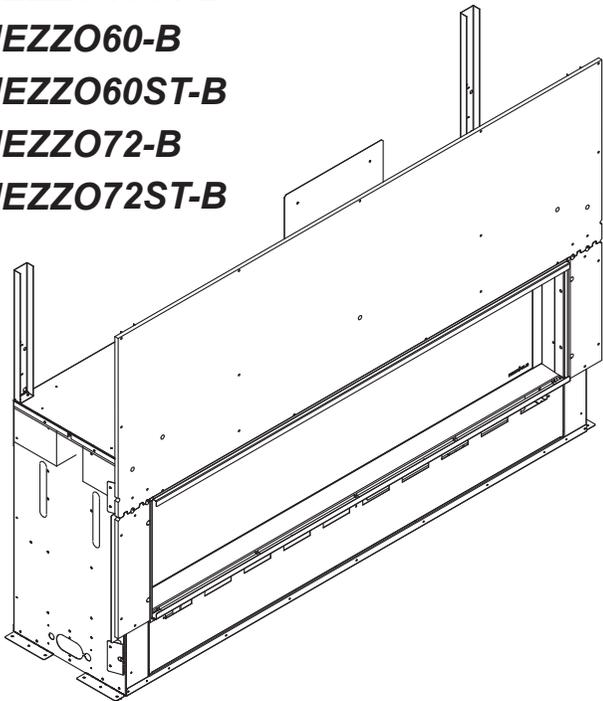
Cet appareil peut être installé en tant qu'équipement d'origine dans une maison préfabriquée (États-Unis seulement) ou maison mobile. Il doit être installé en conformité avec les instructions du fabricant et les *Manufactured Home Construction and Safety Standard, article 24 CFR, alinéa 3280* aux États-Unis, ou aux *Standard for Installation in Mobile Homes, CAN/CSA Z240 MH séries*, au Canada.
