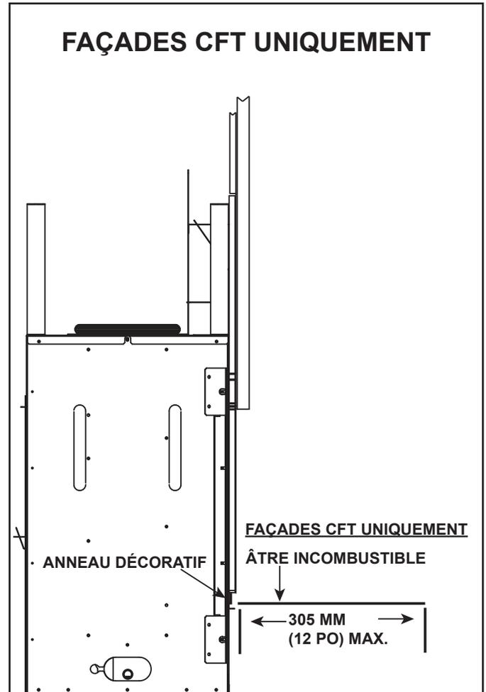
Figure 10.8 Finition et matériaux de revêtement - ajustement intérieur
