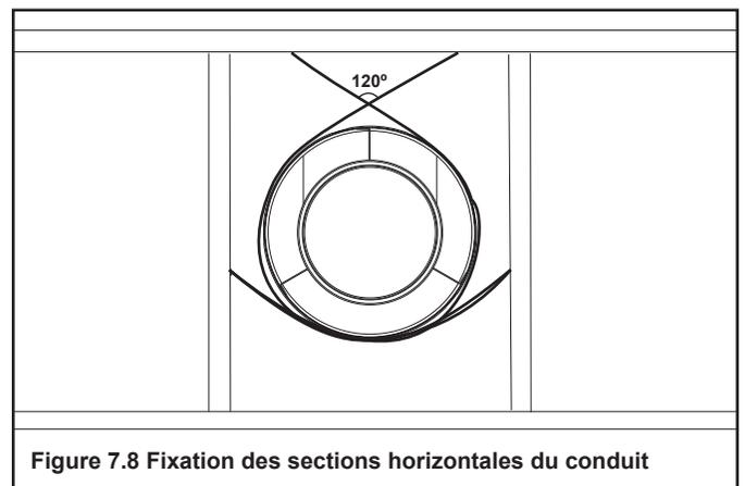
Figure 7.8 Fixation des sections horizontales du conduit
