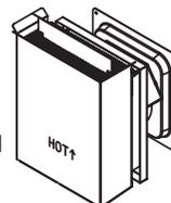
Figure 12.5 Composants PVI-SLP du conduit d'évacuation
