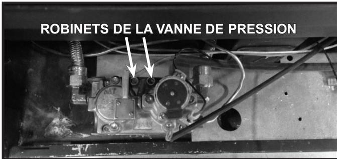
Figure 9.1. Robinets de la vanne de pression.
