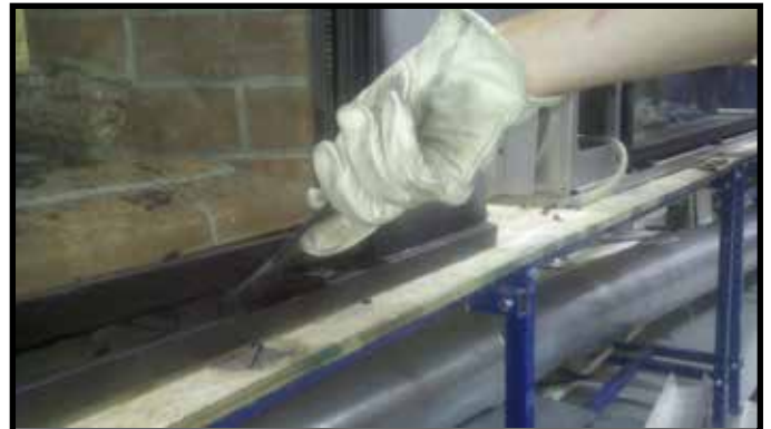
Figure 14.8. Insertion de l'outil de mise en place et de retrait de la vitre
