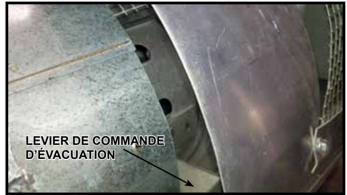
Figure 7.10 Réglage du levier de commande de la PVK-80 – Ouvert
