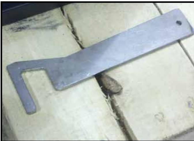
Figure 14.6. Outil de mise en place et de retrait de la vitre
