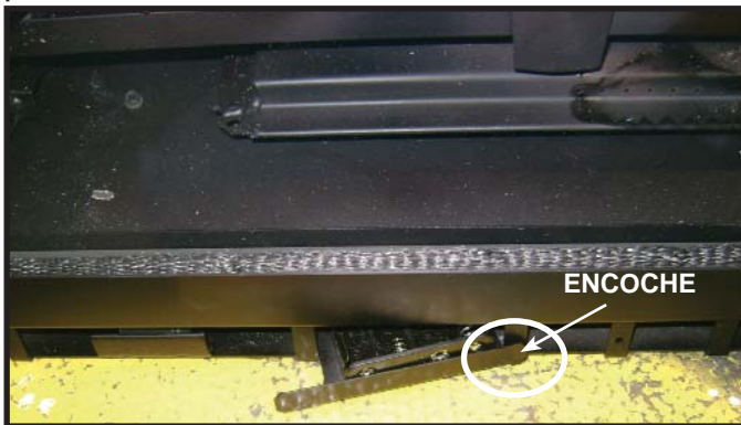
Figure 2.4 Tirer le côté gauche du plateau vers l'extérieur et déclencher l'encoche.
