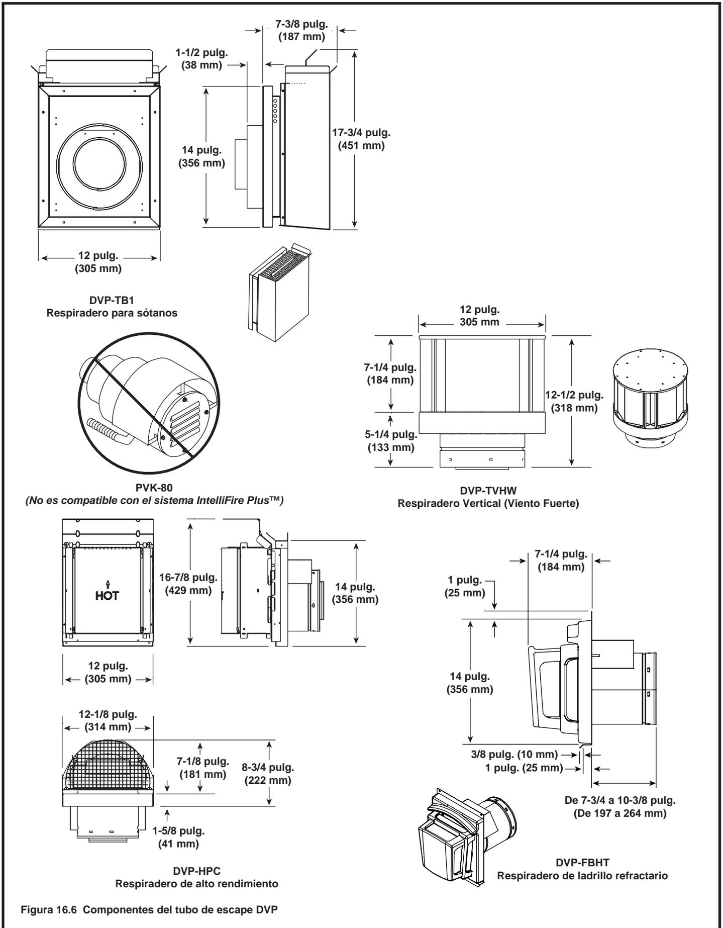
Figura 16.6 Componentes del tubo de escape DVP
