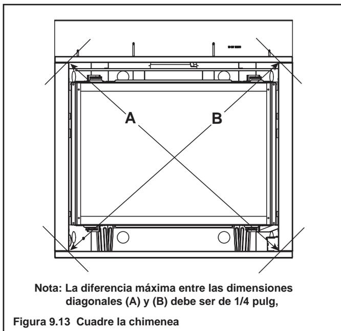
Nota: La diferencia máxima entre las dimensiones diagonales (A) y (B) debe ser de 1/4 pulg,
