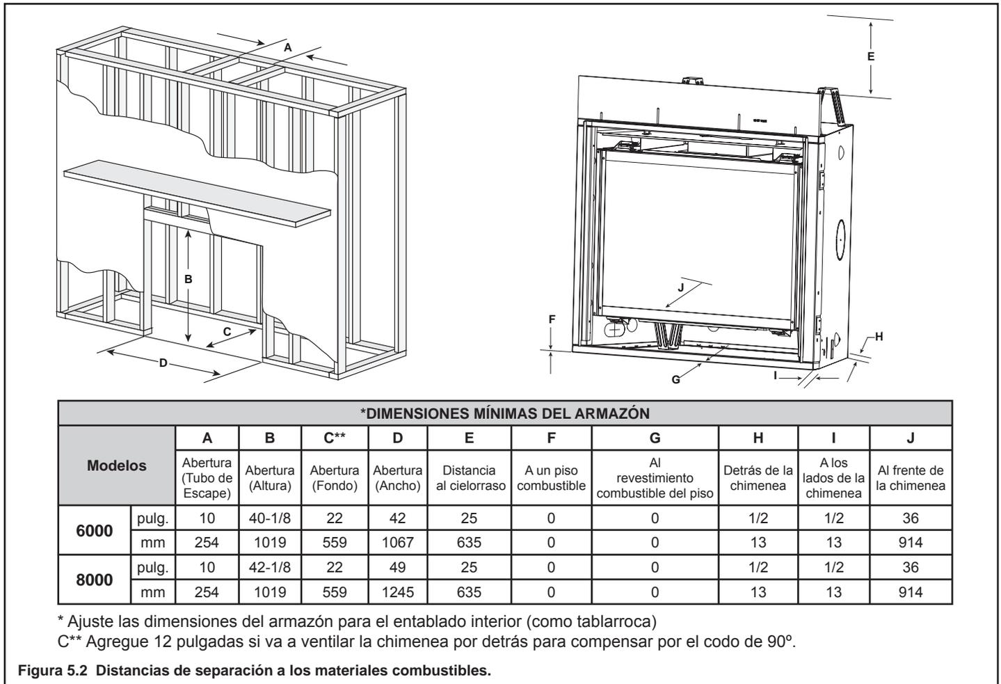
Figura 5.2 Distancias de separación a los materiales combustibles.
