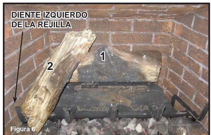
**Leño n° 2 (2166-702):** Encaje la guía de ubicación izquierda que se encuentra en la parte superior del leño n° 1 en el hoyo ubicado en la parte inferior del leño n° 2. Después de encajar la guía de ubicación en el hoyo, encaje el surco ubicado en la parte inferior del leño n° 2 con la barra horizontal de la rejilla y deslice el leño n° 2 hacia la izquierda hasta que descansa en el diente izquierdo de la rejilla.
