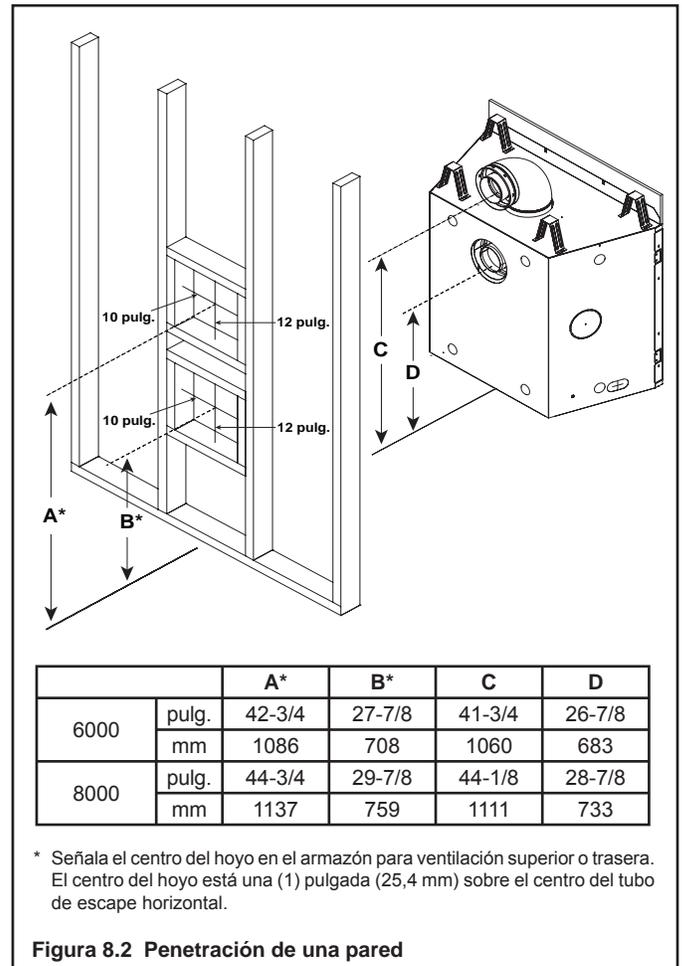
Figura 8.2 Penetración de una pared
