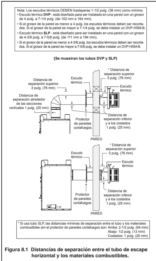
Figura 8.1 Distancias de separación entre el tubo de escape horizontal y los materiales combustibles.
