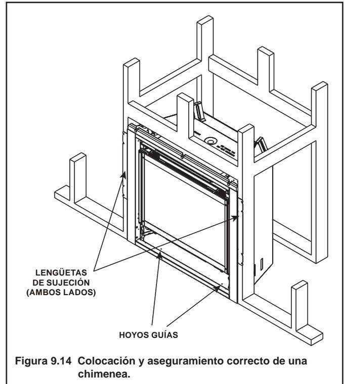
Figura 9.14 Colocación y aseguramiento correcto de una chimenea.
