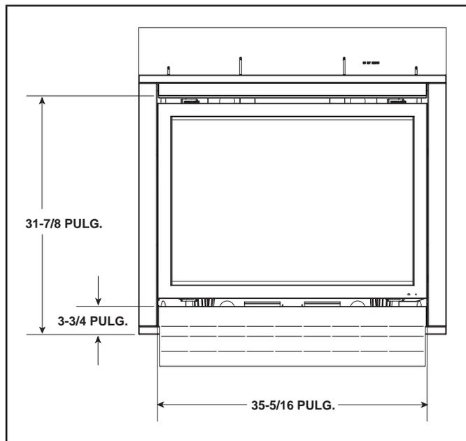
Figura 13.8. Dimensiones de una puerta sin rejillas
