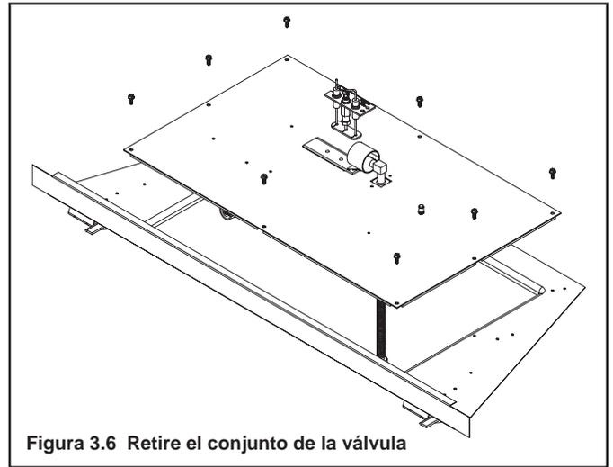
Figura 3.6 Retire el conjunto de la válvula
