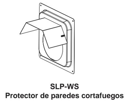
Figura 16.8 Componentes del tubo de escape SLP
