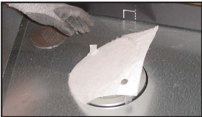
Figure 9.2 Retirez le produit d'étanchéité qui recouvre le capuchon plombé.
