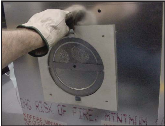
Figure 9.7 Repliez les pattes vers le centre du capuchon plombé (90°) et retirez le panier d'isolant.
