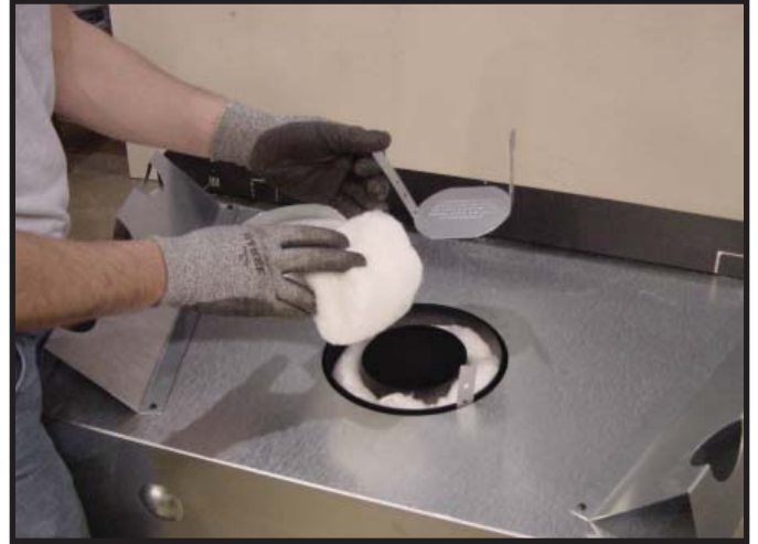
Figura 9.4 Retire el retenedor de aislamiento y saque el aislamiento que está dentro del tubo central.
