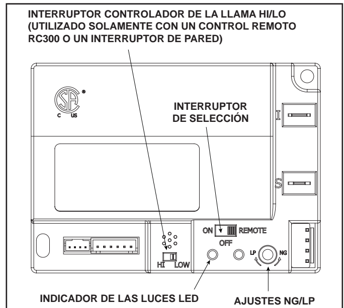
Figura 2.3 Módulo de control
