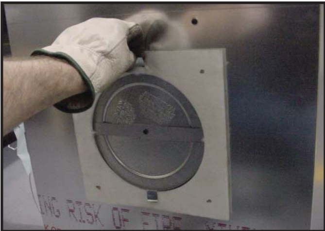
Figura 9.7 Doble las lengüetas hacia el centro de la tapa selladora (90°) y retire la empaquetadura.
