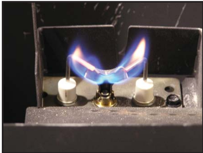
Figura 3.1 Apariencia de las llamas de un piloto IPI
