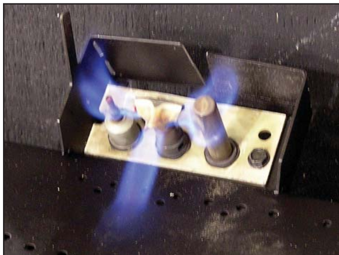
Figura 3.2 Apariencia de las llamas de un piloto fijo
