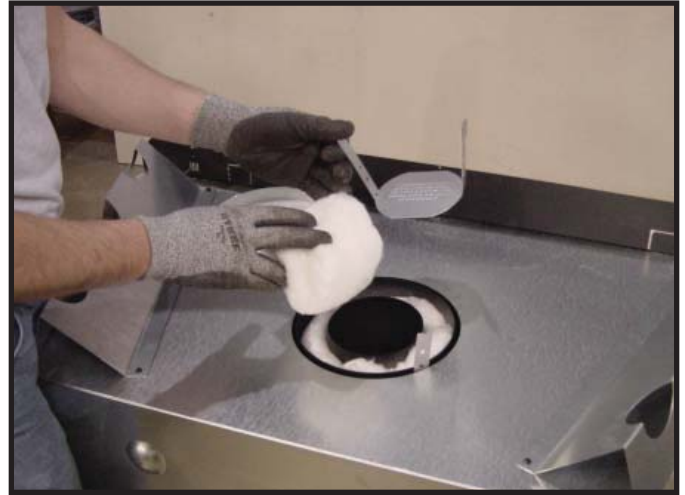
Figura 9.4 Retire el retenedor de aislamiento y saque el aislamiento que está dentro del tubo central.
