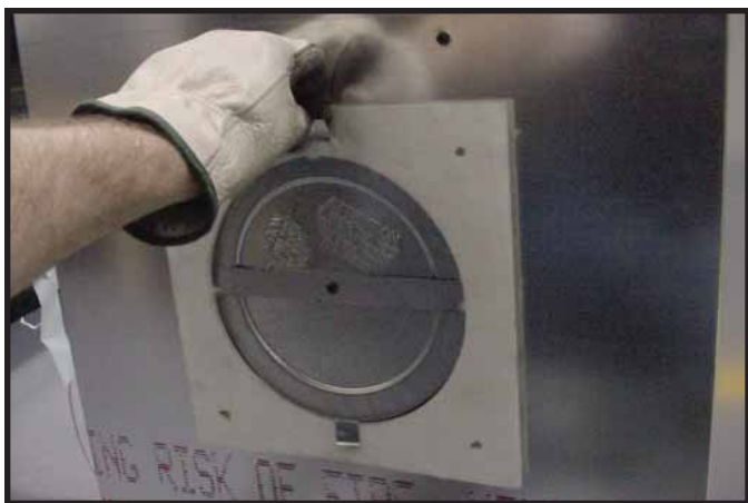
Figura 9.8 Doble las lengüetas hacia el centro de la tapa selladora y retire la empaquetadura de fibra de vidrio.
