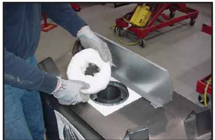
Figura 9.6 Retire el aislamiento del tubo exterior.
