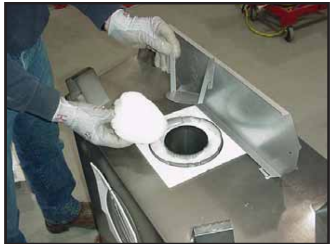
Figura 9.5 Retire el retenedor de aislamiento y el aislamiento que se encuentra dentro del tubo central.
