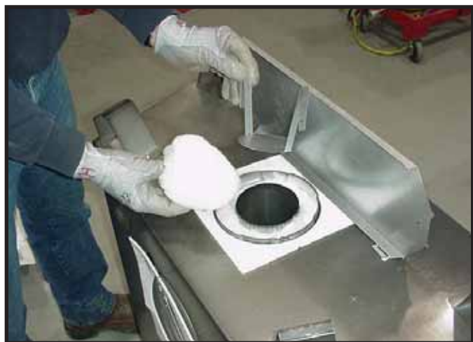
Figure 9.5 Retirer le panier isolant et l'isolant blanc du tuyau du conduit d'évacuation central.
