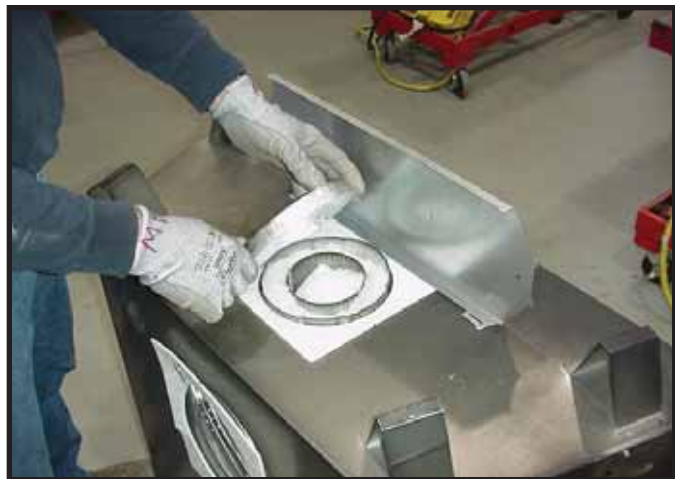
Figure 9.4 Retirer le capuchon d'évent.
