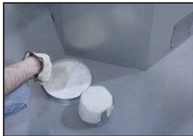
Figure 9.11 Jeter le capuchon d'évent, et retirer et jeter le panier d'isolation. Note : Une fois le capuchon d'évent retiré, il ne peut être rattaché.
