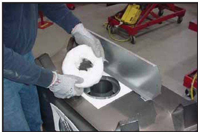
Figure 9.6 Retirer l'isolant du tuyau du conduit d'évacuation extérieur.
