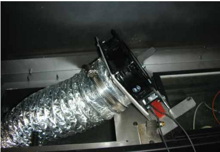
Figure 8.16 Retrait du ventilateur par le trou de la boîte à feu
