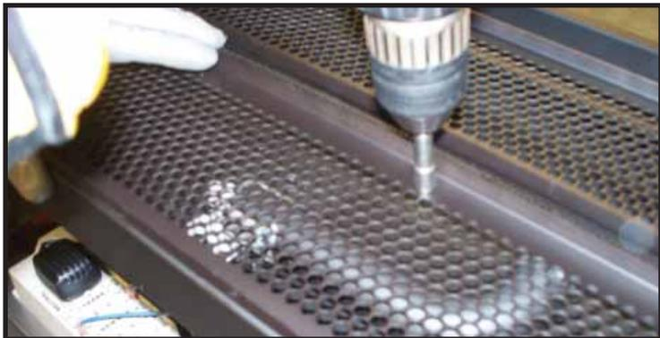
Figure 8.9 Retirer les vis du bac de base.
