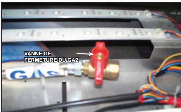
Figure 9.4 Accès au raccord du gaz
