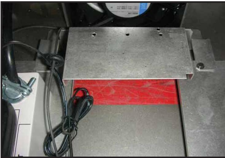
Figure 8.15 Support de montage du ventilateur
